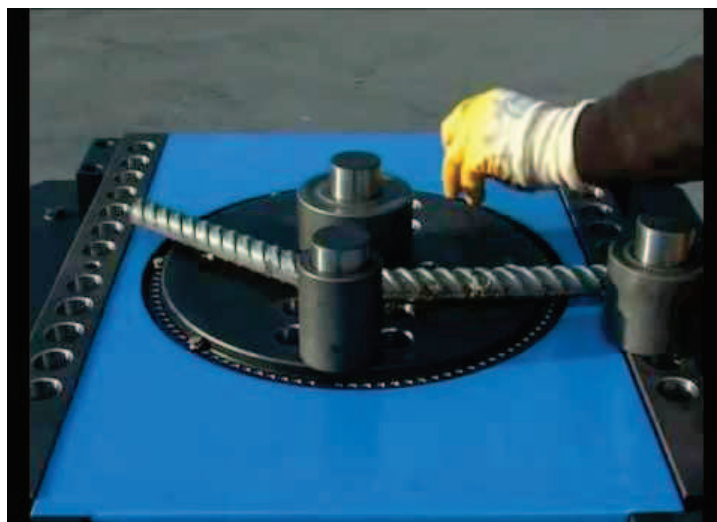
Figura Nº 27 Doblado de la varilla con maquinaria.
