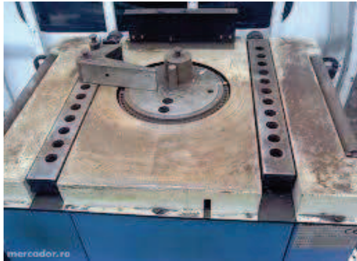
Figura Nº 26. Dobladoras de varilla eléctrica recomendados para trabajos a pie de obra.
