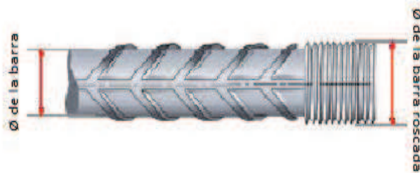
Figura Nº 28 Extrusión de varilla.
