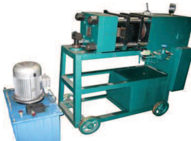
Figura Nº 30. Extrusora en frío Linying Building Materials technology Co, Ltd.
