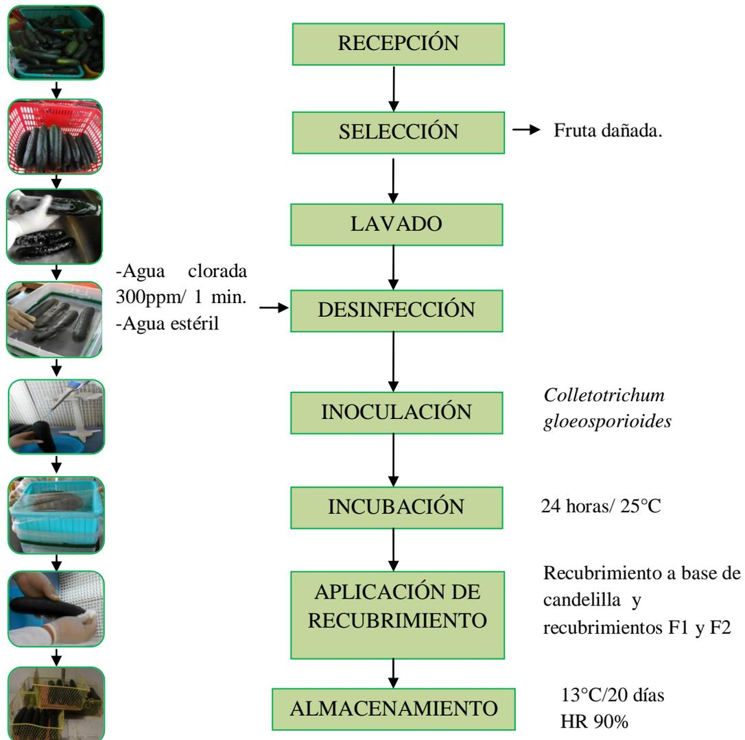
Figura 9. Diagrama de proceso para la aplicación de recubrimientos en pepino.
