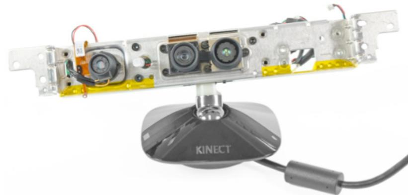
Ilustración 75- Cámara Kinect sin la carcasa exterior. Tomada de (Borestein, 2012).
