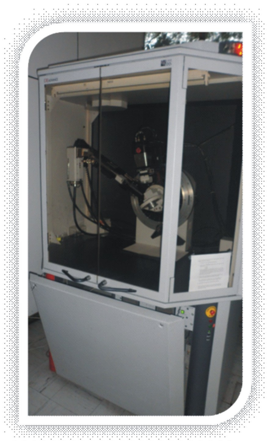
Figura 3.3: Difractómetro de rayos X D8.
