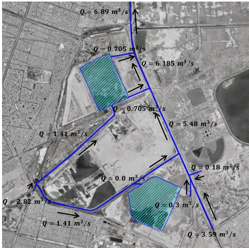
Fig 4.10 Sistema hidráulico con los gastos base supuestos en cada canal
