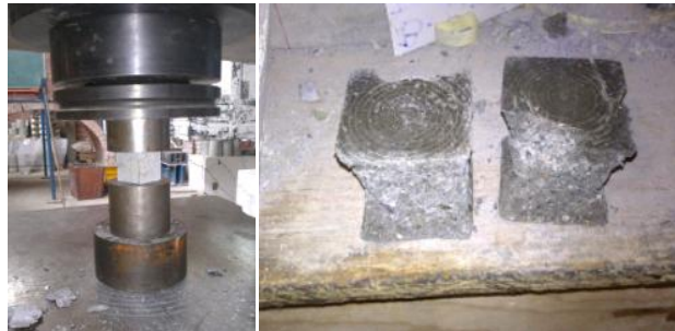
Fig 5.12 Ensayo a compresión simple de probetas cúbicas de 5 cm de arista, antes y después de la prueba.
