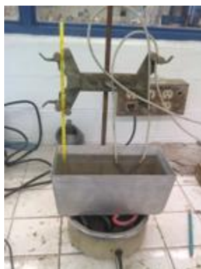
Fig 3.9 Calibración de datalogger.
