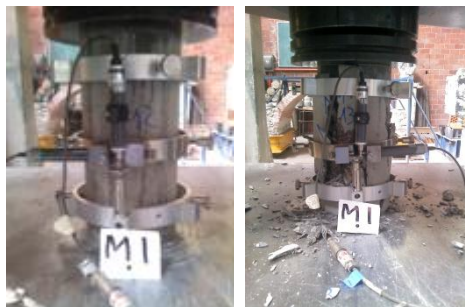
Fig 5.8 Ensayo de cilindros para determinar el módulo de elasticidad y la relación de Poisson, antes y después de la prueba.
