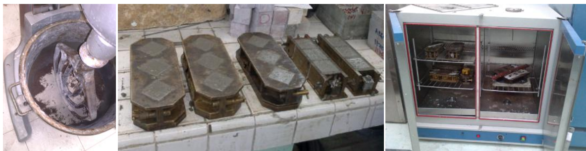
Fig 4.2 Elaboración y curado del mortero.
