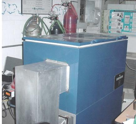
**Figura 3.1** Cámara para ensayos acelerados de corrosión atmosférica [Sánchez *et al.*, 2005]
