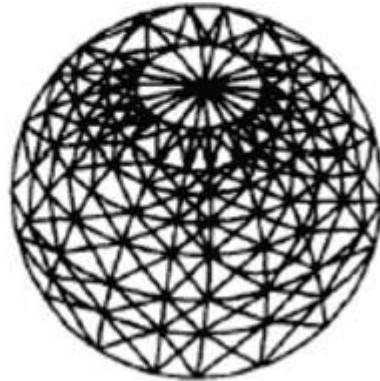
Figura 15 Aproximación de una esfera mediante caras triangulares en un STL
