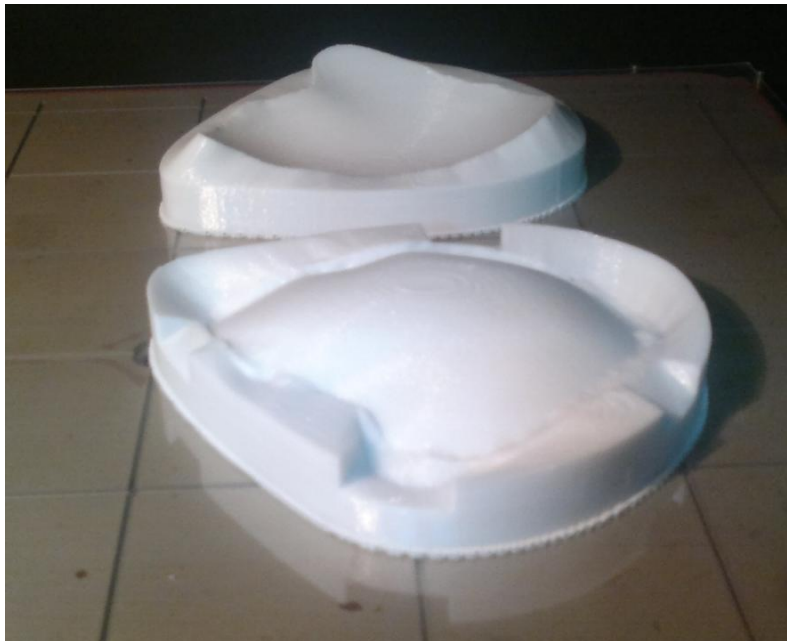
Figura 33 Construcción del molde en la máquina FDM Fortus 400mc.
