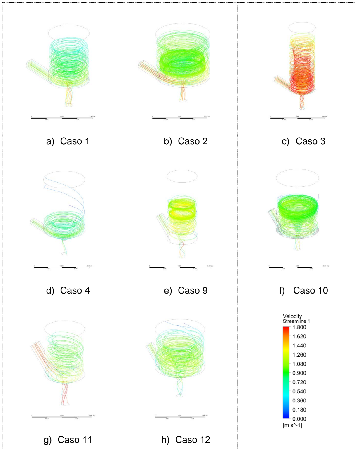
Figura 12. Trayectoria y velocidad de las partículas trazadoras dentro del dispositivo mezclador con ausencia de una barrera.
