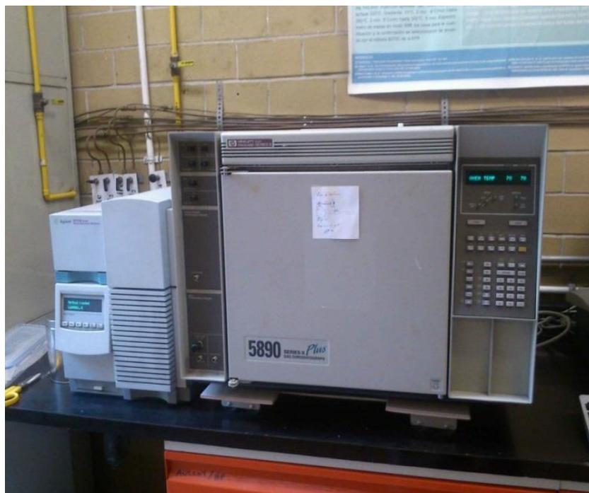
Figura 16. Cromatógrafo de gases Hewlett Packard 5890 Serie II Plus acoplado a un espectro de masas cuadrupolar Agilent 5973N.
