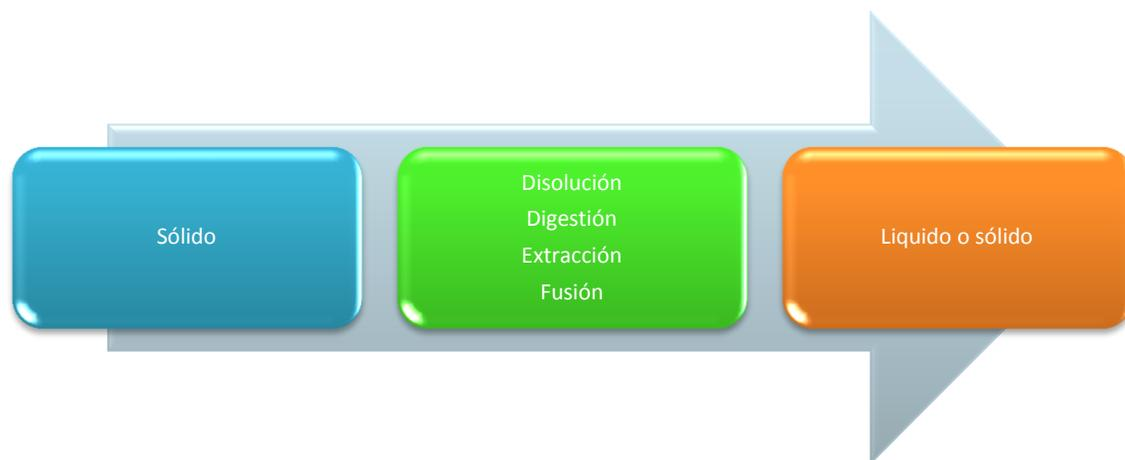
Figura 8. Mecanismo de cambio de una matriz de estado sólido a otro.
