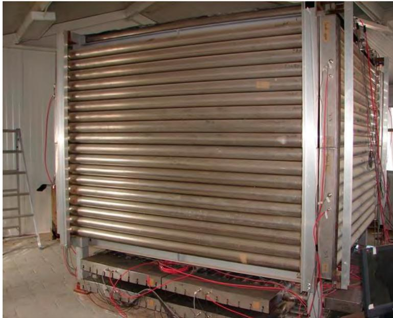
Figura 2.1: El Telescopio de neutrones solares se encuentra en estación en la cima del volcán Sierra Negra. El sitio es conocido por albergar otro experimento importante, el Gran Telescopio Milimétrico. Las dimensiones del detector son: 280 cm de alto y 266 cm de largo y ancho.
