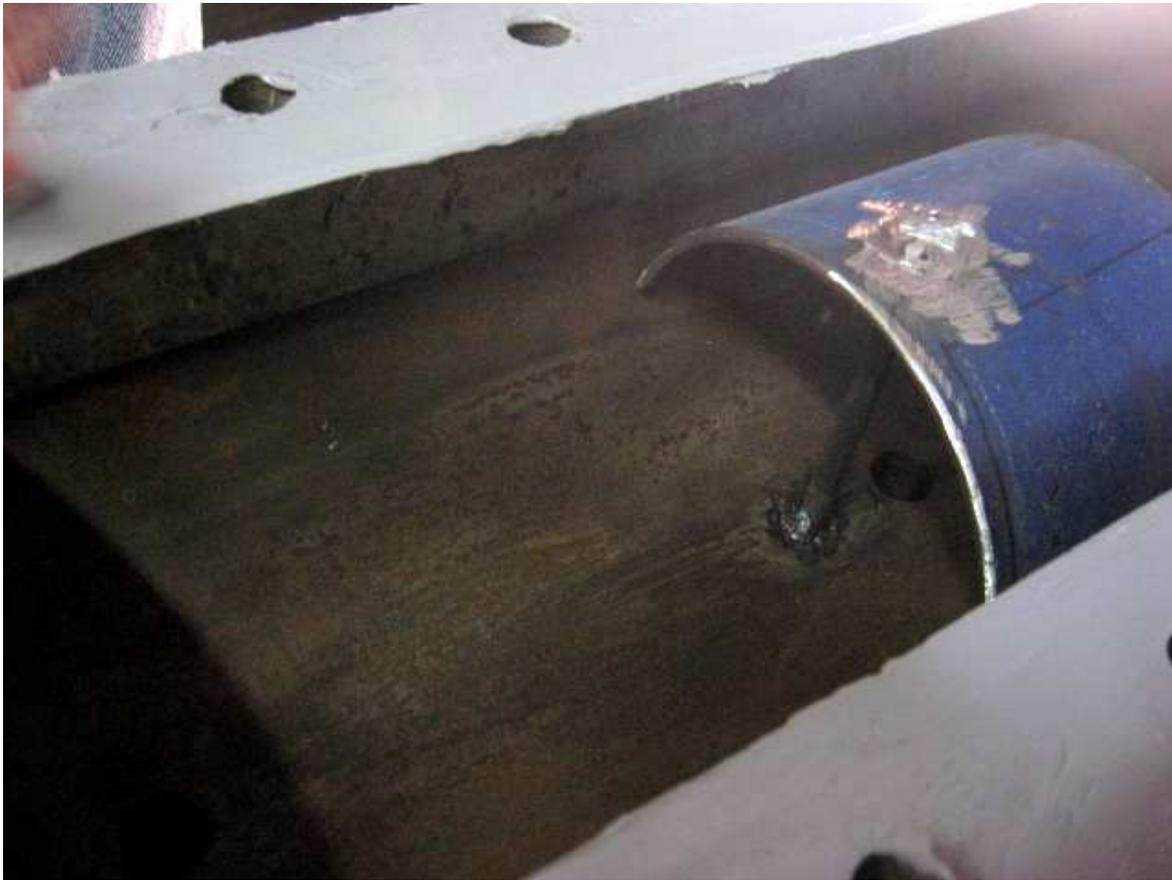
Figura 2.5: Distribuidor del vapor de amoníaco.
