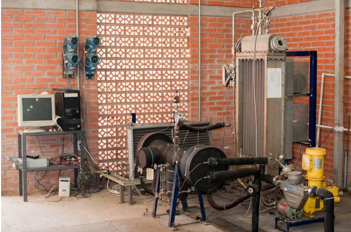
Figura 3.1: Prototipo de refrigerador por absorción y sistema de adquisición de datos.
