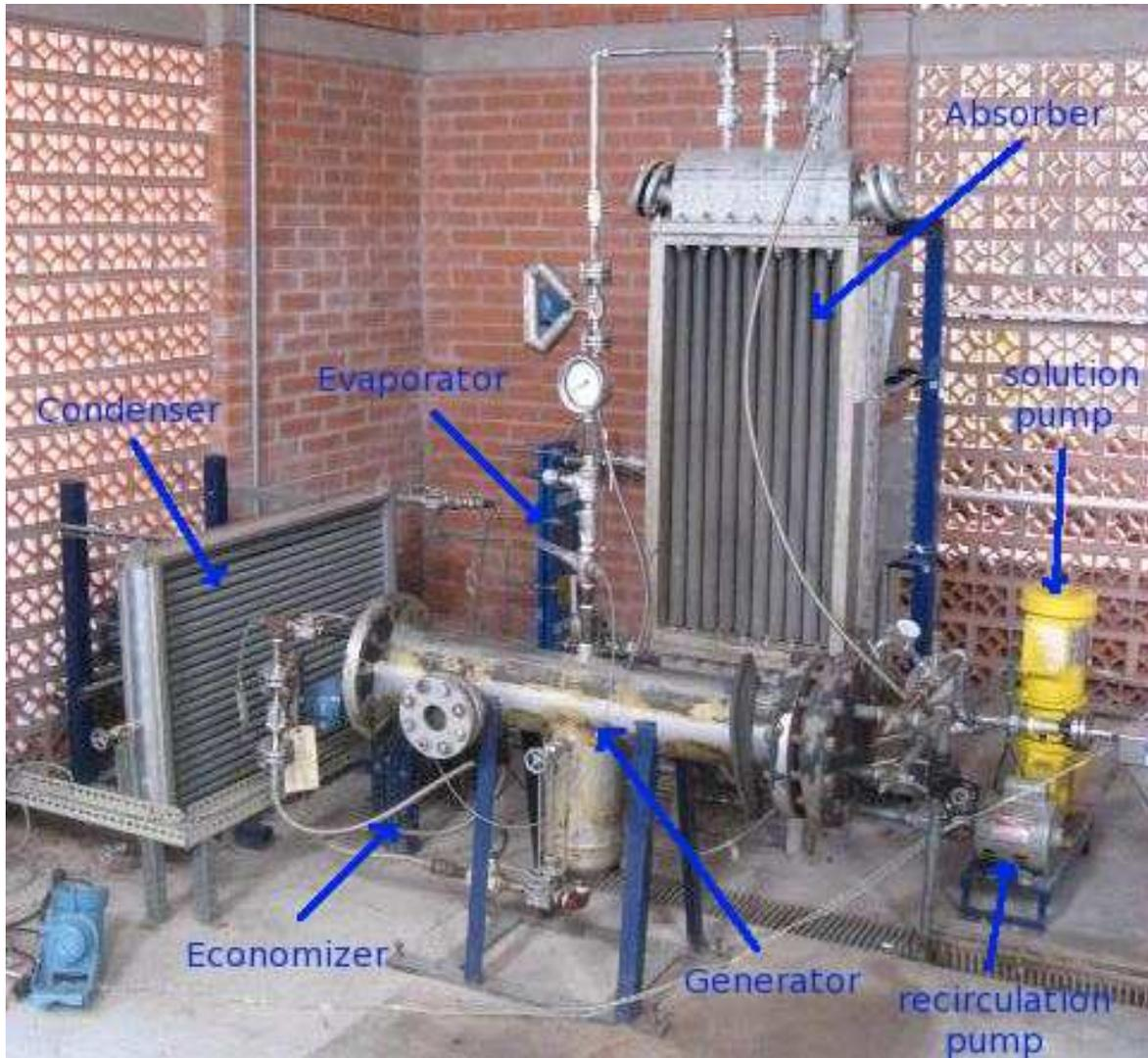
Figura 3.3: Prototipo del sistema de refrigeración por absorción.
