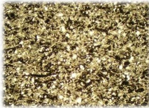
**Figura 3.4.** Muestra de lutita bajo el microscopio 10X.
