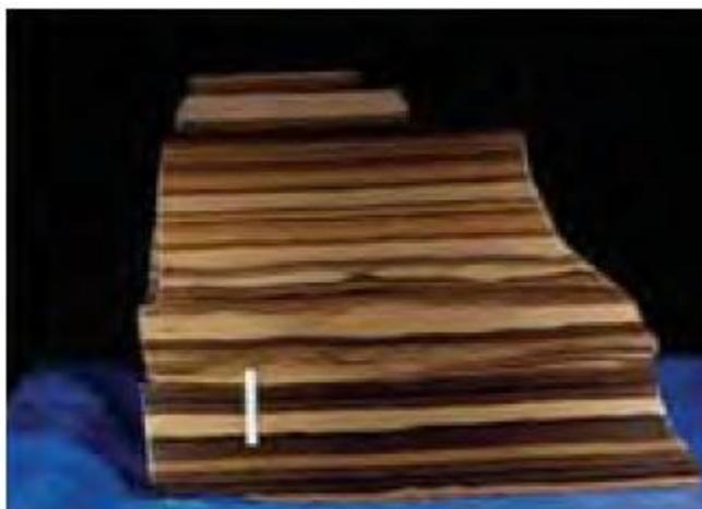
**Figura 3.2.** Muestra de una formación de lutitas obtenida de la formación Green River, en la cuenca Piceance Creek de Colorado.<sup>ii</sup>
