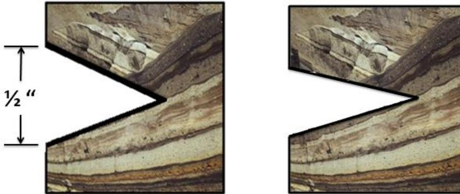
**Figura 4.16.** Fractura hidráulica abierta, al liberar la presión tiende a cerrarse la fractura.
