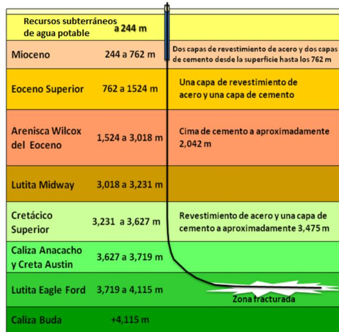
**Figura 4.8.** Esquematación de la perforación horizontal en una formación de lutitas del Play Eagle Ford.
