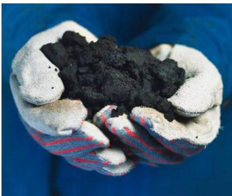
**Figura 3.11.** Arenas bituminosas.
