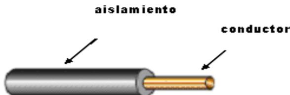
Figura 3.2.1. Se muestra el aislamiento del conductor.
