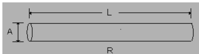
Fig. 2.2.3 La resistencia se encuentra a partir de la resistividad del material, así como de sus dimensiones geométricas.
