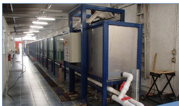
Figura 119.- Canal de oleaje del Laboratorio de Costas y Puertos del Instituto de Ingeniería de la UNAM.
