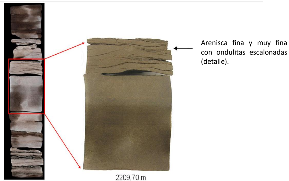
Figura 4.2. Aspecto de la litofacies 2 en un núcleo procedente del pozo 236, en el campo Presidente Alemán (Modificado de PEMEX, 2010).
