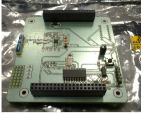
Figura 1.5. Subsistema de Comunicaciones de SATEDU.
