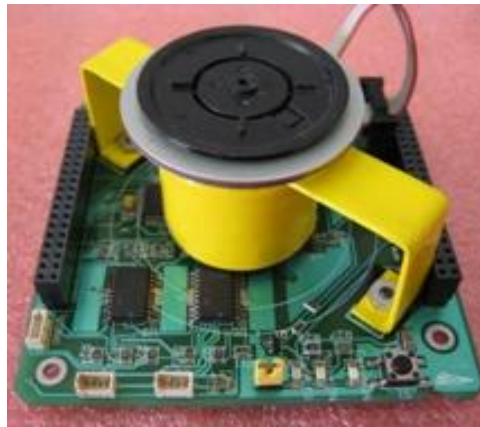
Figura 1.4. Subsistema de Estabilización de SATEDU.
