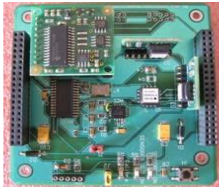
Figura 1.6. Subsistema de Sensores de Estabilización de SATEDU.
