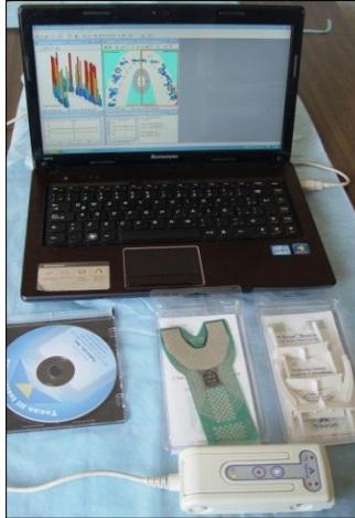
Figura 7. Sistema T-Scan III, software, unidad de sistema, sensores y porta sensores.
