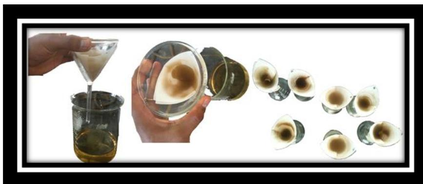
**Figura 22.** Filtrado de las muestras hidrolizadas.
