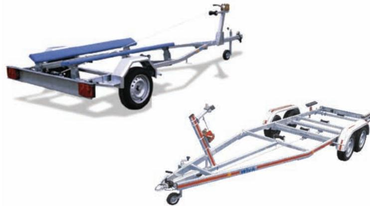
**Remolque para Embarcaciones.** Destinados para el transporte de vehículos acuáticos.
