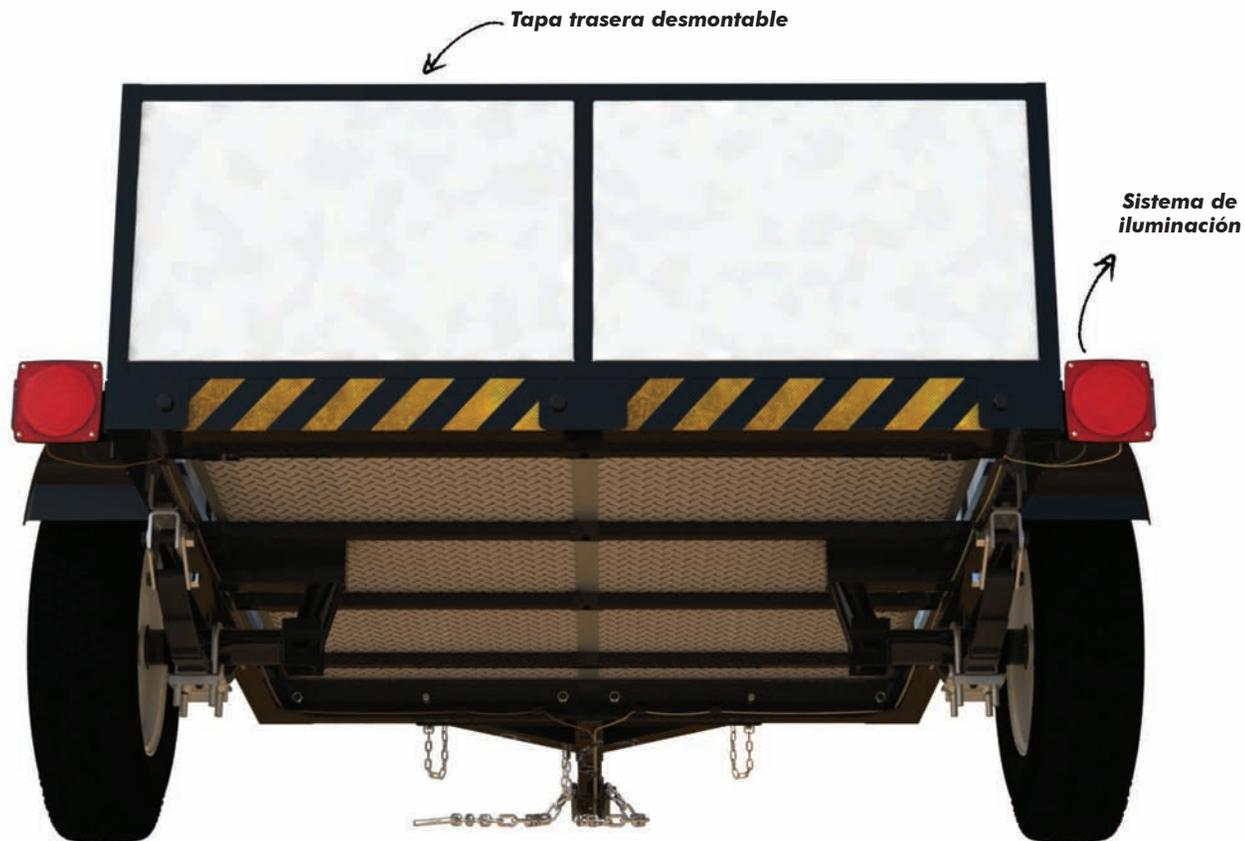
Estructura inferior donde podemos apreciar la suspensión sin eje, los travesaños que soportan el piso, la colocación de los cables del sistema eléctrico y el piso dividido en dos de lámina antiderrapante.
