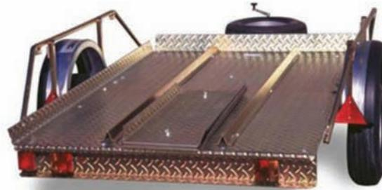
**Remolque para Vehículos.** Destinados al transporte de motos, cuatrimotos, automóviles, entre otro tipo de carga.
