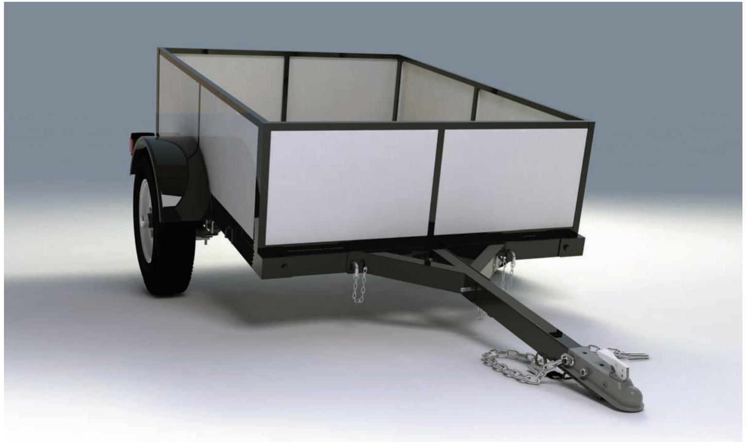
El remolque cuenta con un diseño sencillo y funcional, se proyecta para soportar 1000kgr. de carga, no cuenta con frenos pero sí con luces traseras; por su diseño particular, no tiene un eje convencional proponiendo así, una suspensión fuera de lo común.
