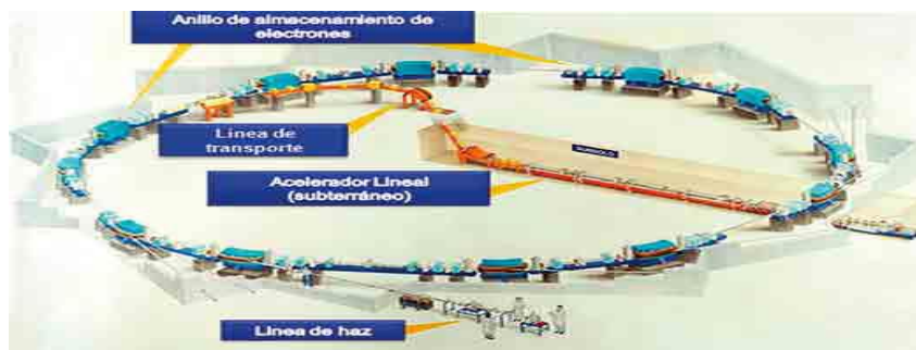
Figura. 46. Esquema de un sincrotrón. Espectroscopía de absorción de rayos-X [150,151]
