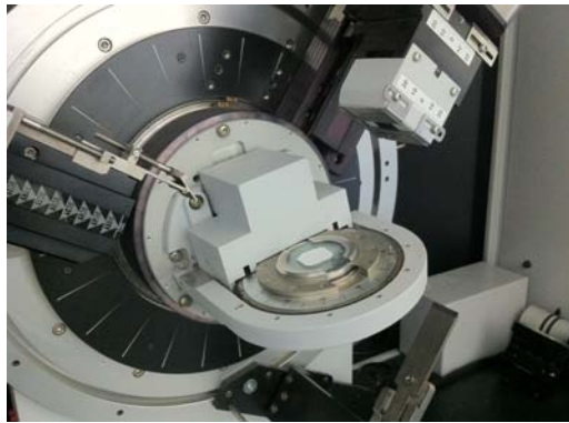
Imagen 27. Difractómetro Bruker D8 advance.
