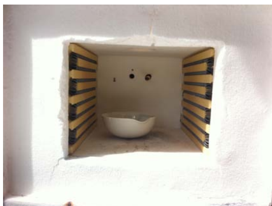
Imagen 71. Calcinación de la película depositada.
