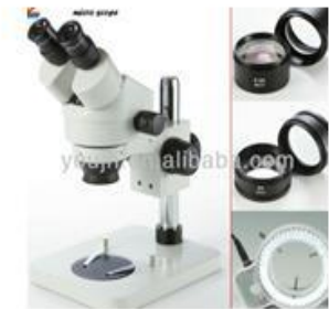
MICROSCÓPIO ESTEREOSCÓPICO Proporciona focalidad para la elaboración de mapas dactilares.
