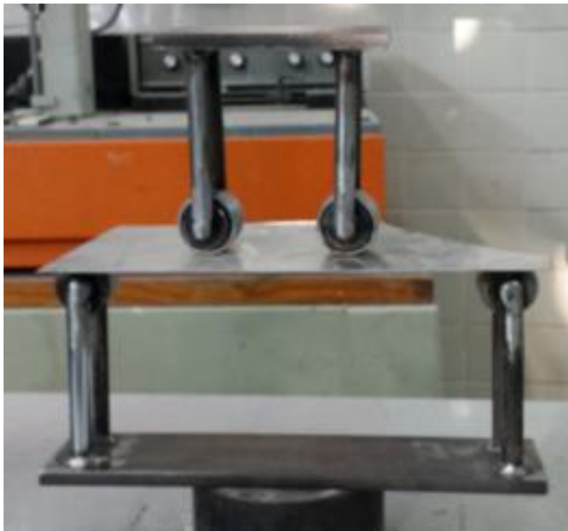
Figura 5. Fotografía de dispositivo de cuatro puntos fabricado como objetivo de esta tesis
