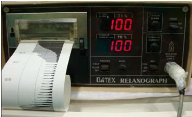
Figura 2 . Electromiógrafo. Relaxograph NMT (Datex Instrumentarium Oy, Helsinki, Finlandia). Se observa papel de registro en tiempo real del TOF.
