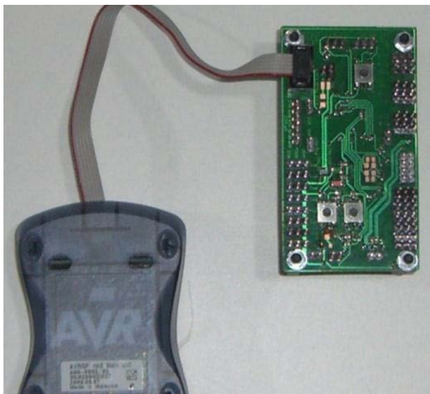
Figura 4-70: Tarjeta del microcontrolador e interfaz de programación
