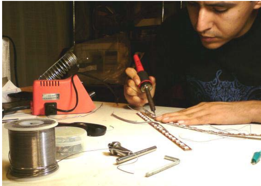
Figura 5-7 : Soldadura de las secciones de LED's.
