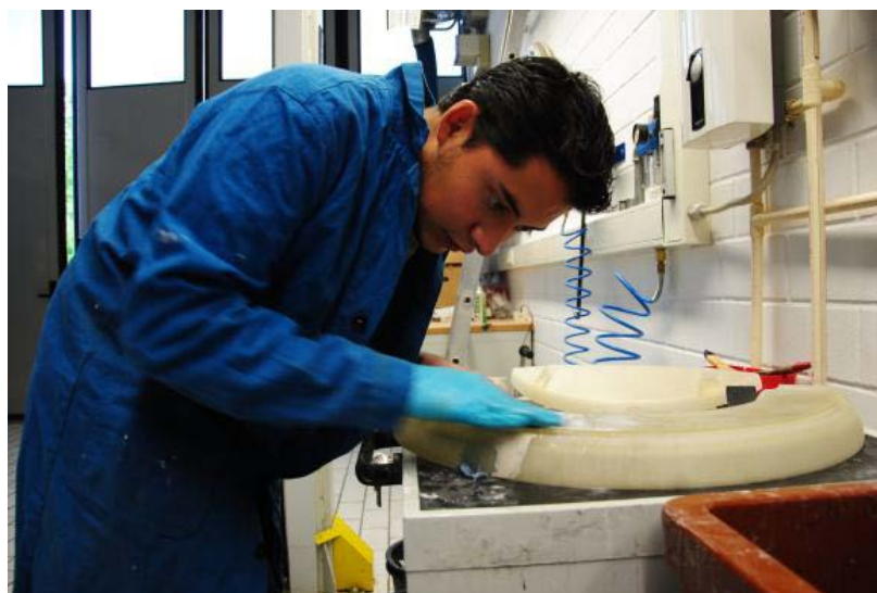
Figura 5-5: Lijado de las cubiertas
