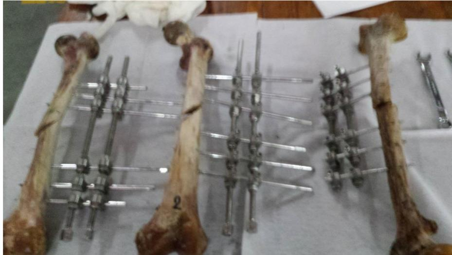
**FIGURA 14. Modelos posterior ser sometidos a pruebas biomecánicas en flexión, con dispositivo de 4**
