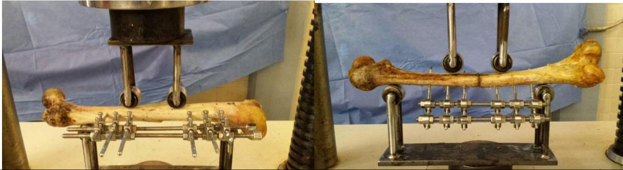
**FIGURA 11. Prueba biomecánica en flexión en el plano coronal y sagital.**
