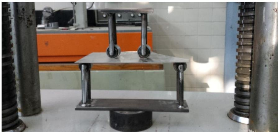
**FIGURA 14. Dispositivo de 4 puntos SQ.**
