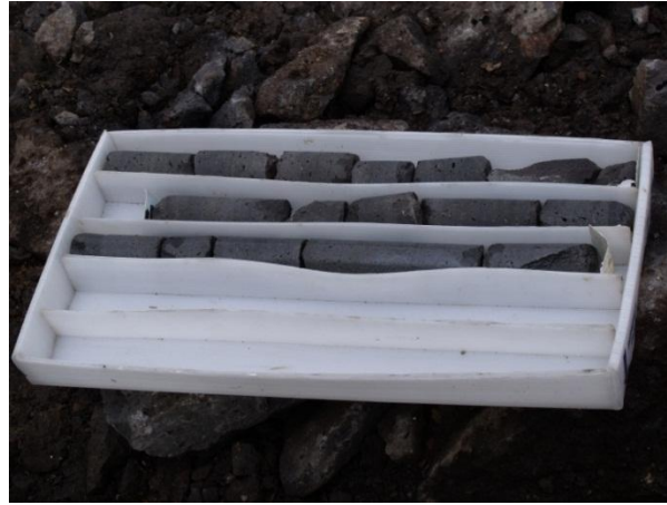
Figura 3.15. Muestras obtenidas mediante sondeo con equipo rotatorio.
