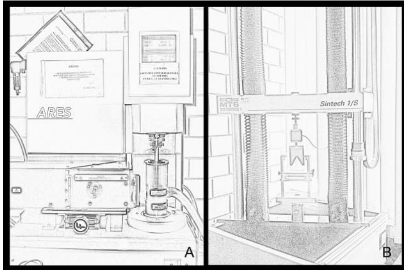
Figura 3. Representación esquemática de las máquinas utilizadas para la medición de las pruebas mecánico-reológicas. A. Reómetro con cizalla angular oscilatoria. B. Máquina de pruebas mecánicas con celda Warner-Bratzler.
