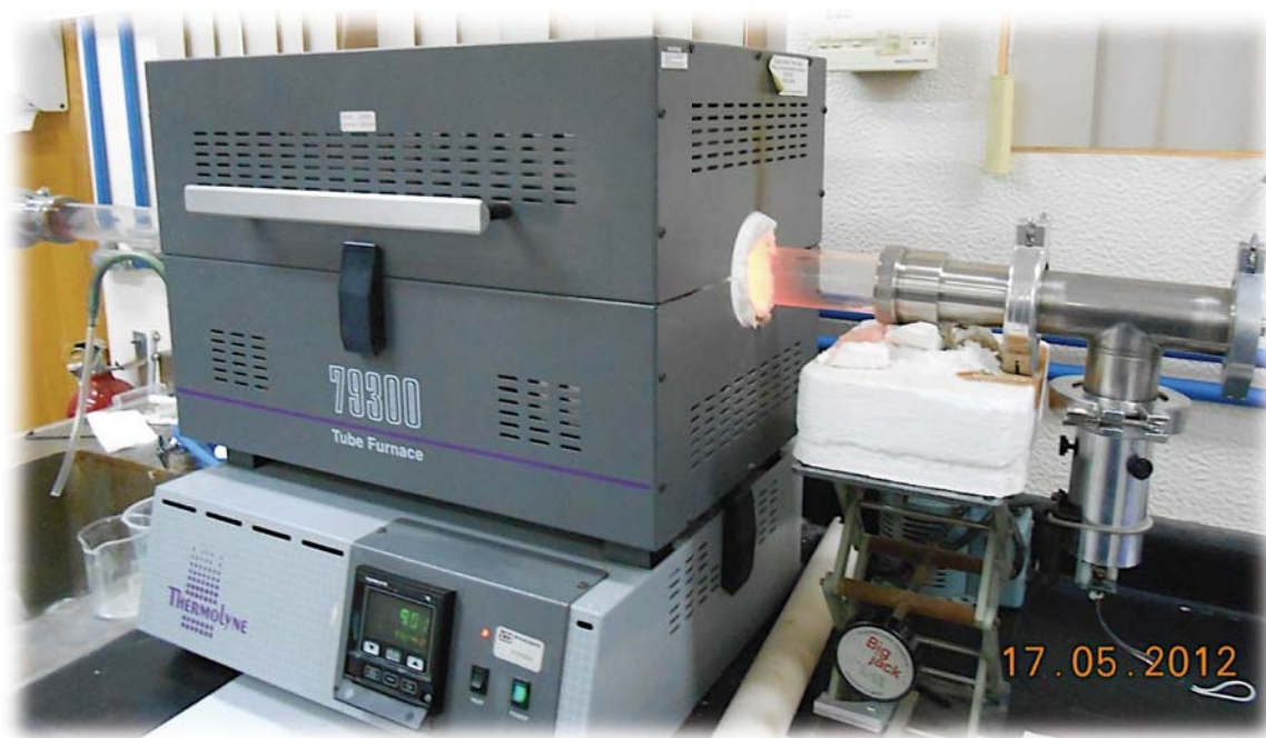
Figura 14. Sistema de spray pirólisis del Centro de Nanociencias y Nanotecnología- UNAM.
