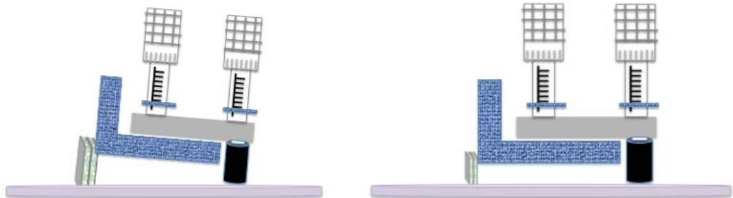
Figura 28. Uso del tripod para pulir la muestra.
