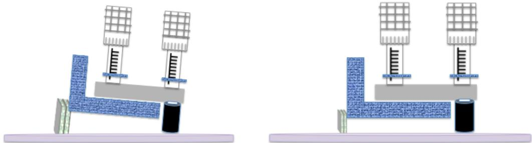
**Figura 28.** Uso del *tripod* para pulir la muestra.
