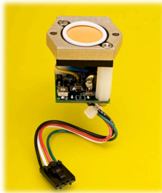
**Figura 16.** Nebulizador ultrasónico Sonaer<sup>®</sup>.
