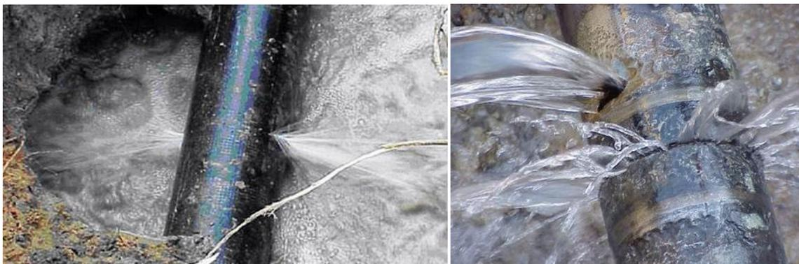
**FIGURA 4. 10 TUBERÍAS CON FALLOS DE TIPO ORIFICIO**
