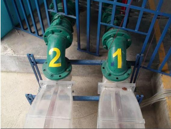
*Foto 1. Tubos de aspiración y válvula de bola para simular las maniobras de toma y rechazo de carga de las turbinas*
