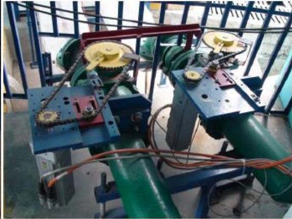
*Foto 2. Servomotores para simular maniobras de toma y rechazo de carga de las turbinas*
