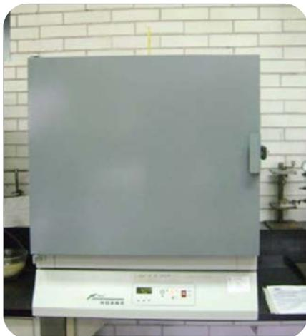
**Fotografía 29.** Pre-acondicionamiento de las muestras en humedad y temperatura controladas.
