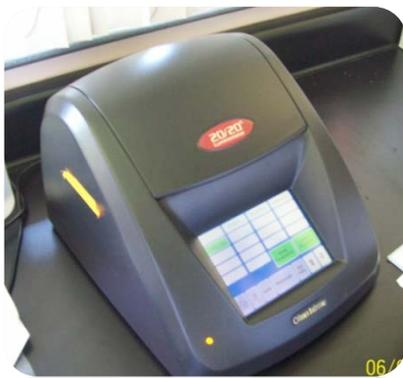
**Fotografía 42.** Luminómetro para cuantificar la adherencia de *Cándida albicans*, expresada en URL's.
