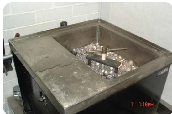
**Fotografía 12.** Una vez cerrada la mufla se introduce con todo y prensa a la unidad de termopolimerizado.
