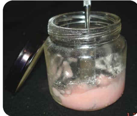
**Fotografía 10.** En un frasco seco y limpio de vidrio, se vierte primero el líquido y después el polvo. Este paso se aplica para las tres resinas comprendidas en este estudio.
