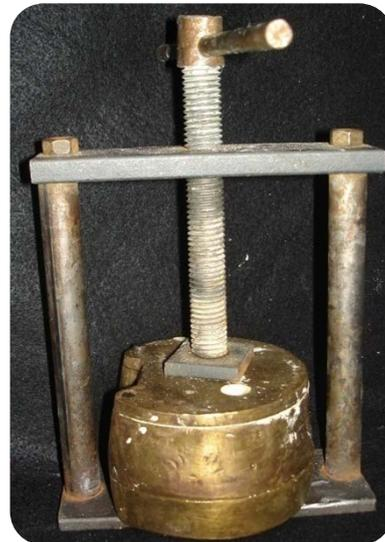
**Fotografía 8.** Cerrado y prensado de la mufila mientras se produce la reacción de fraguado del yeso.
