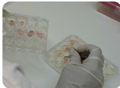
**Fotografía 40.** Colocación de las muestras de PMMA en cada pozo.
