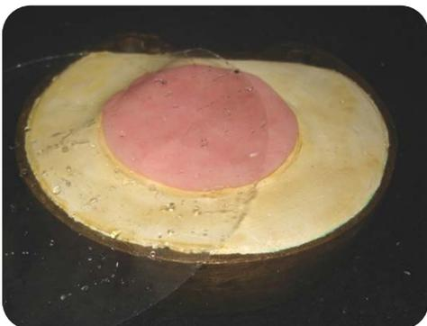
**Fotografía 11.** Se coloca una hoja de polietileno húmeda previo al prensado.
