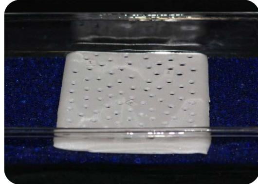
**Fotografía 24.** Rejilla dentro del desecador, lista para colocar las muestras.
