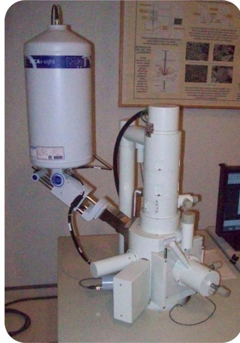
**Fotografía 6.** Microscopio Electrónico de Barrido.
