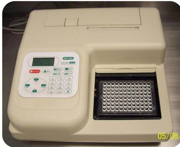
**Fotografía 38.** Colocación de la placa en el lector de ELISA
