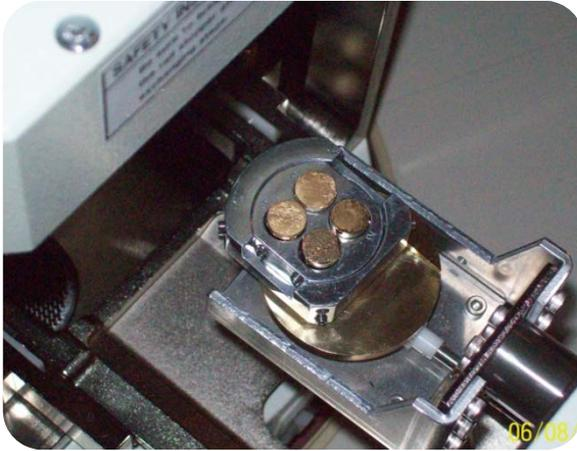
**Fotografía 5.** Colocación de los portaobjetos en la platina del microscopio.
