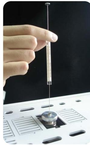
**Fotografía 22.** Inyección al cromatógrafo.
