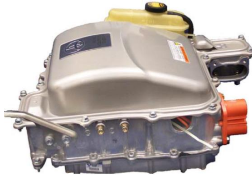
Figura 6.2. Inversor y convertidor de voltaje. (ref.36)
