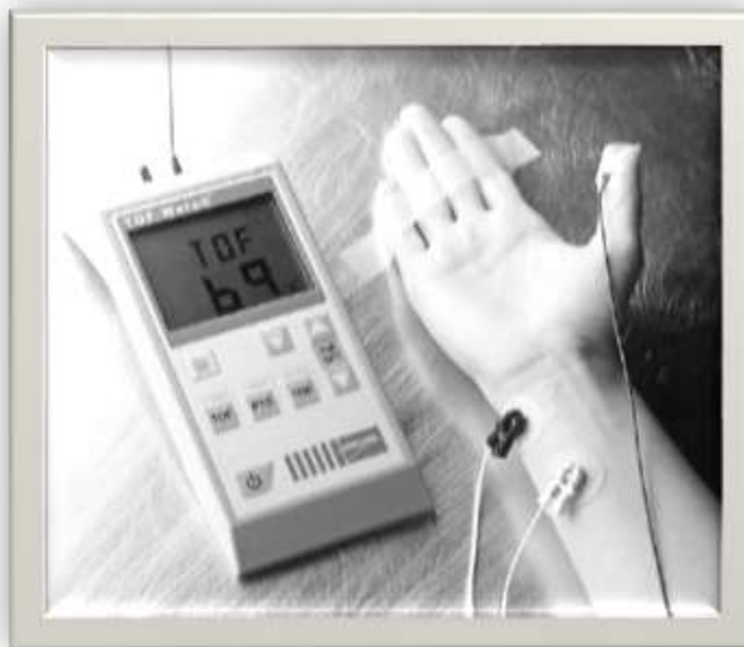
Figura 4. TOF Watch. El monitor consta de un microprocesador, dos electrodos de estimulación positivo y negativo y un acelerómetro
