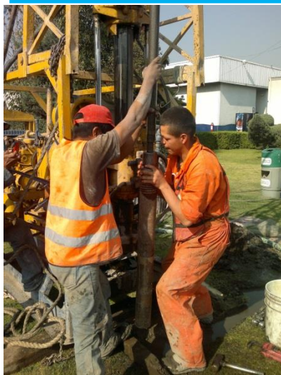
COLOCACIÓN DEL TUBO DE PARED DELGADA (TUBO SHELBY)
