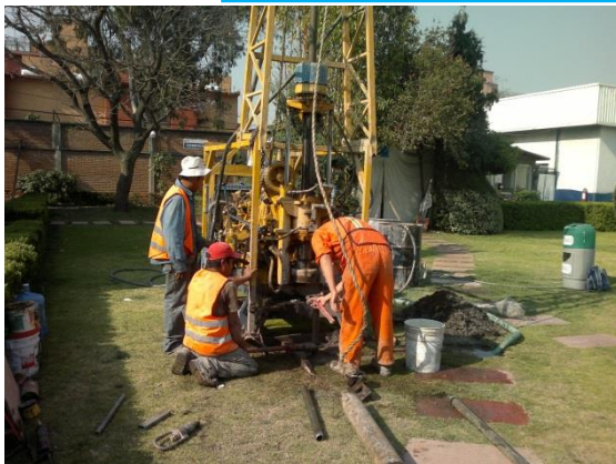
COLOCACIÓN DEL TUBO PARTIDO E INICIO DE LA PRUEBA DE PENETRACIÓN
