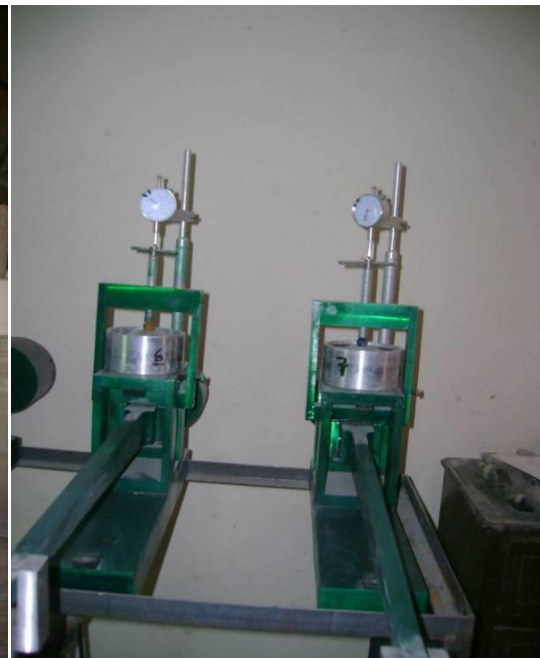
PRUEBA DE CONSOLIDACIÓN
