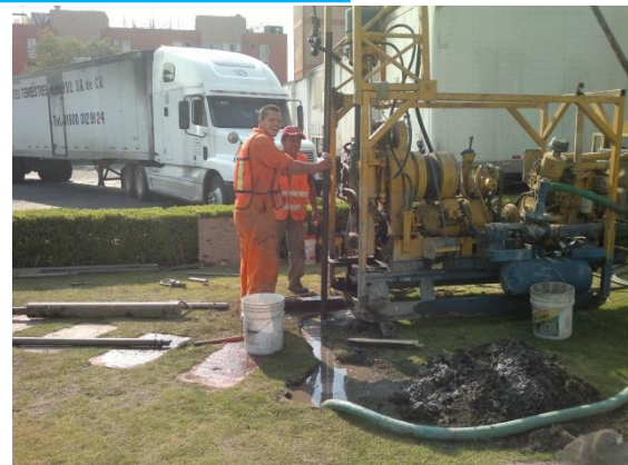
COLOCACIÓN DEL TUBO PARTIDO E INICIO DE LA PRUEBA DE PENETRACIÓN
