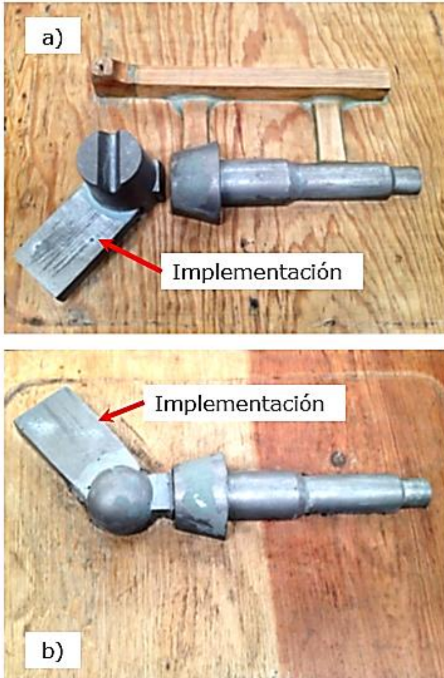
Figura 26. Modificación de la placa modelo para dar cabida al molde de cobre permanente. a) Parte superior y b) Parte inferior.
