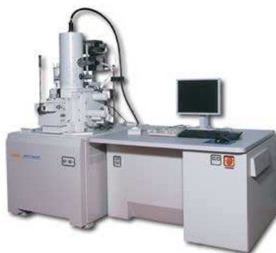
Figura 2.9. Microscopio electrónico de barrido JEOL JSM-7600F.
