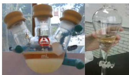
Figura 2.4. Imágenes de la mezcla de reacción (izquierda) y separación de las fases líquidas con un embudo de separación (derecha).
