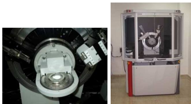
Figura 2.7. Difractómetro Bruker AXS D8 Advance.
