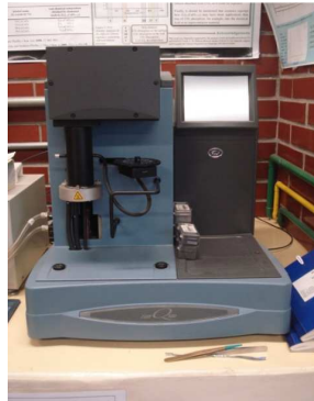
Figura 2.21. Termobalanza TA Instruments modelo Q500HR.
