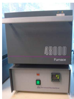
Figura 2.1. Mufla Barnstead Thermolyne 4800 utilizada en la síntesis de las muestras cerámicas.
