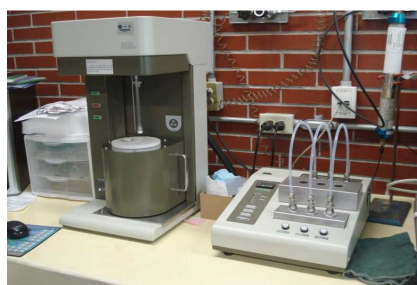
Figura 2.12. Equipo Belsorp II mini, Bel Japan, Inc. (izquierda) y equipo Belprep II vac, Bel Japan, Inc. (derecha)
