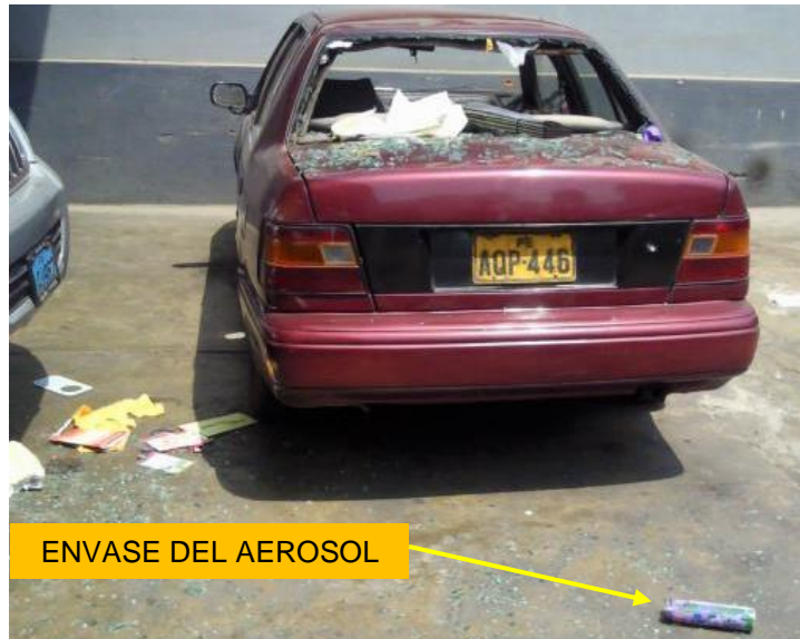
Explosión de un aerosol por dilatación térmica en el interior de un automóvil.
