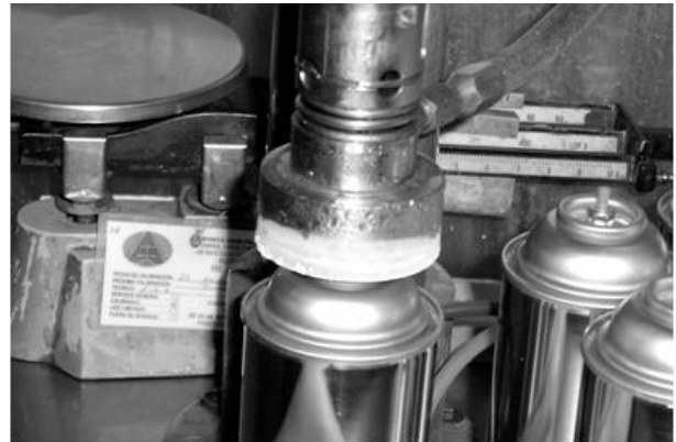
Aquí la fuga por envase fue tan elevada que se congeló el adaptador.
