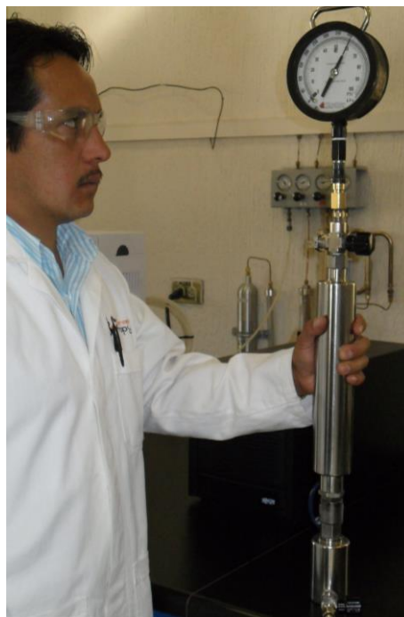
Equipo requerido para medir la presión de vapor ASTM, del PHC.
