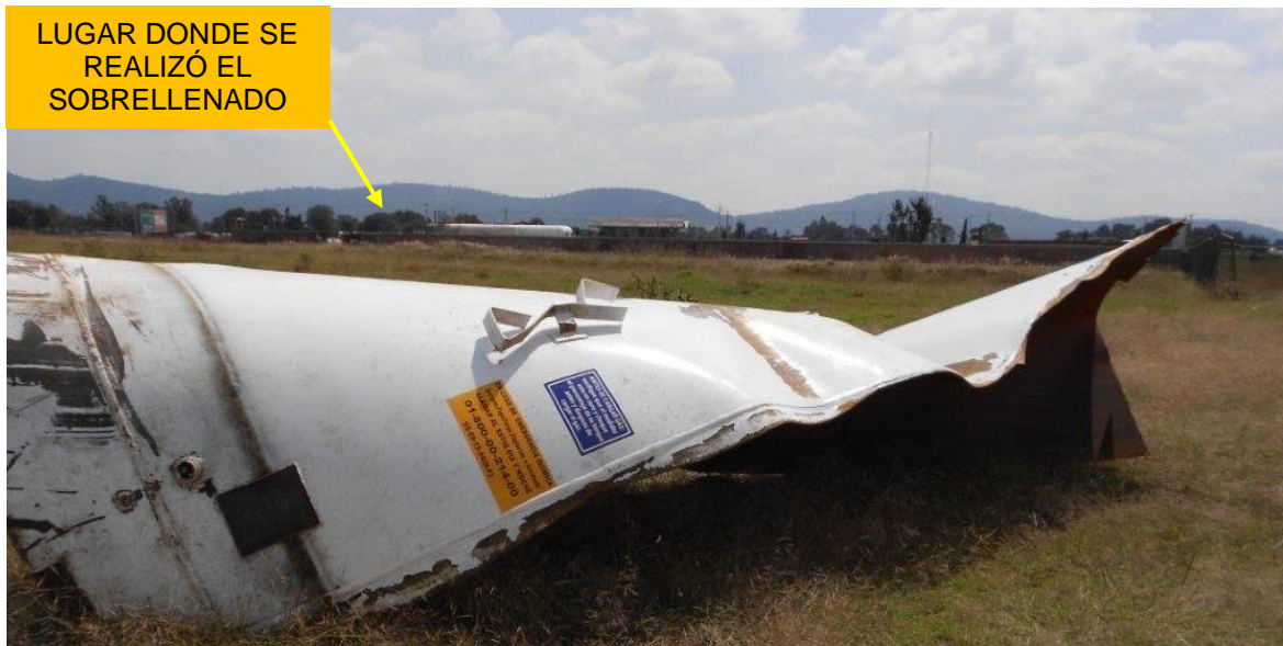
Resultados por sobrellenado de un autotanque con gas LP (al fondo se ve la Planta).
