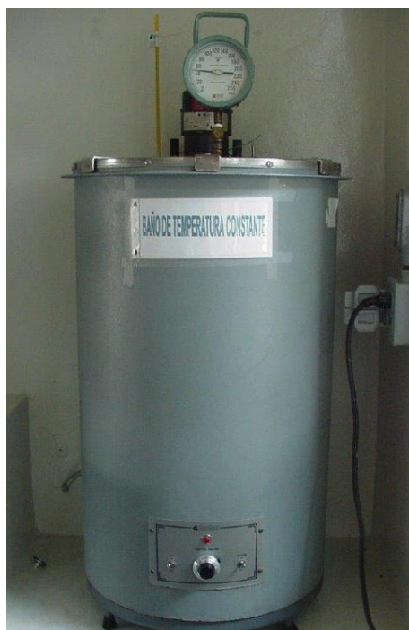
Equipo requerido para medir la presión de vapor ASTM, del PHC.
