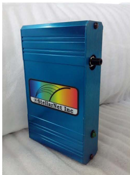
Figura 5.5. Espectrómetro empleado para el registro de la intensidad transmitida de la luz.
