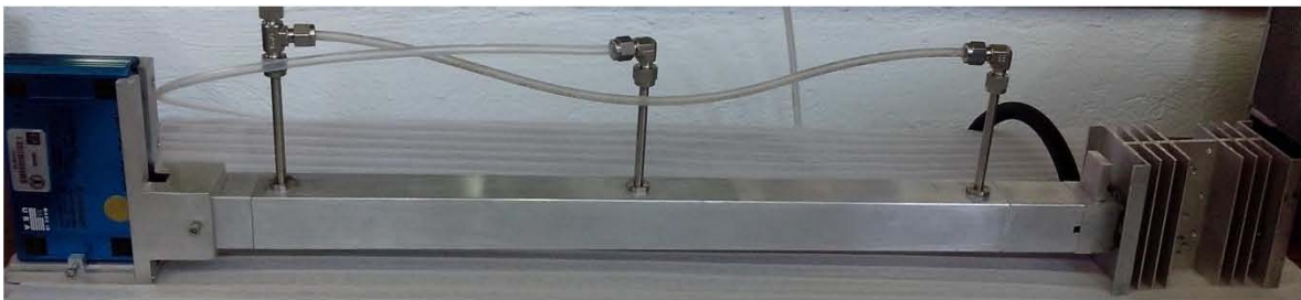
Figura 5.2. Espectrómetro construido con las medidas exactas al diseño.
