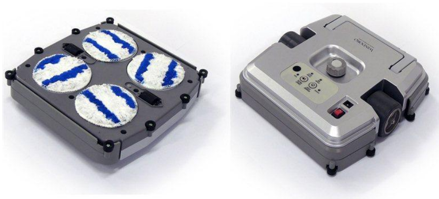
Figura 3.5 Sistema guía y seguidor de Windoro.
