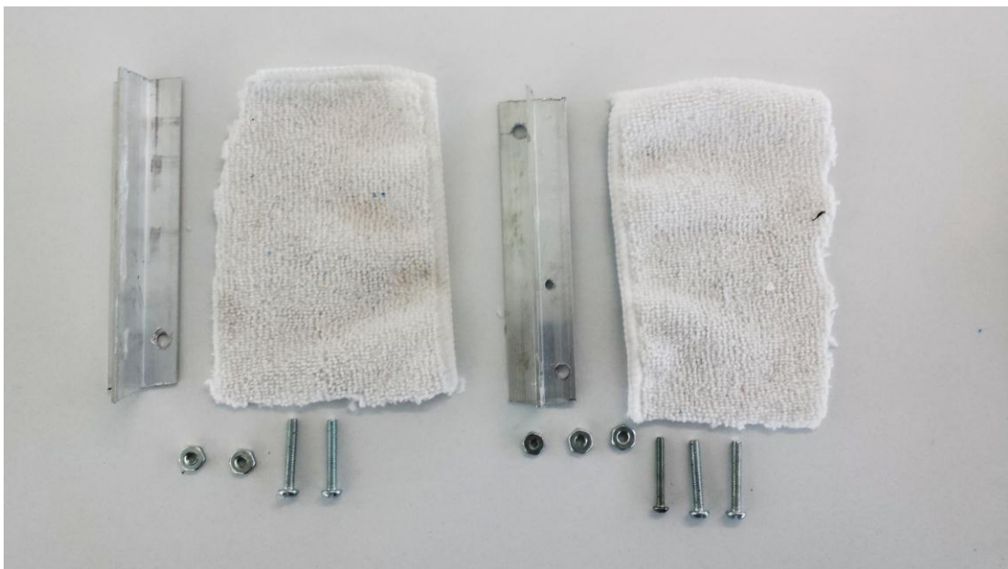
Figura 10.13 Guías de aluminio y sus cubiertas de microfibra.
