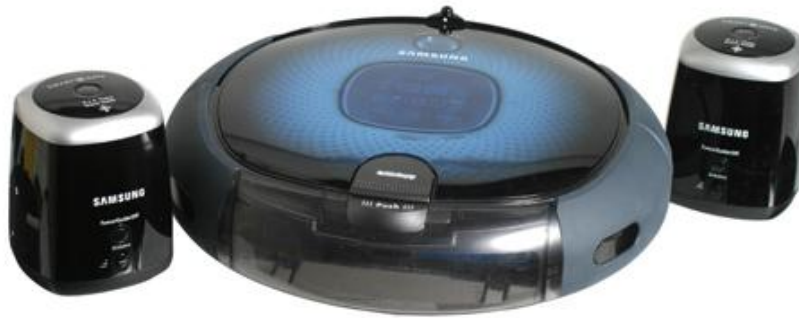
Figura 3.7 Sistema Navibot con sus elementos de delimitación de área.
