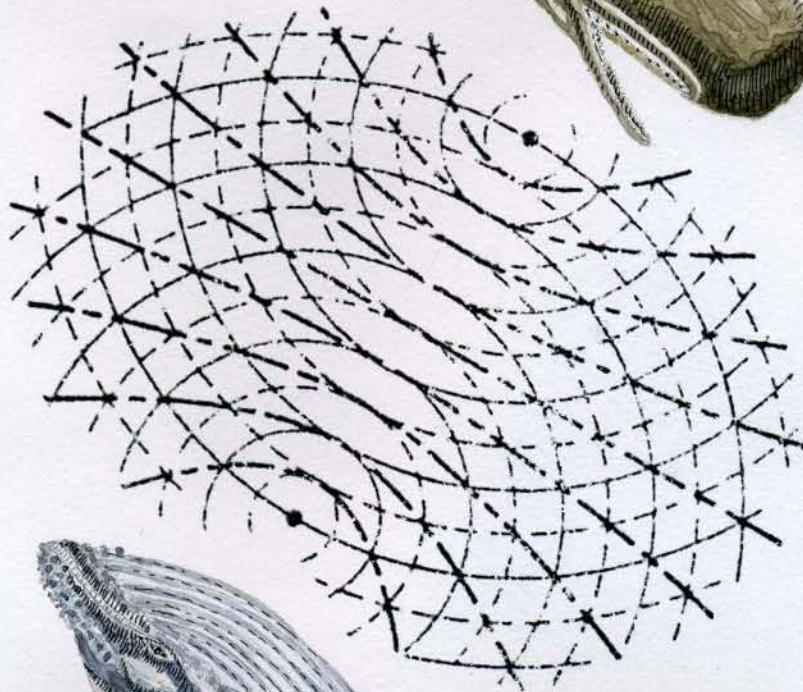
Fig. 25-18. Apariencia de las ondas estacionarias producidas en una superficie líquida por dos focos vibratorios.
