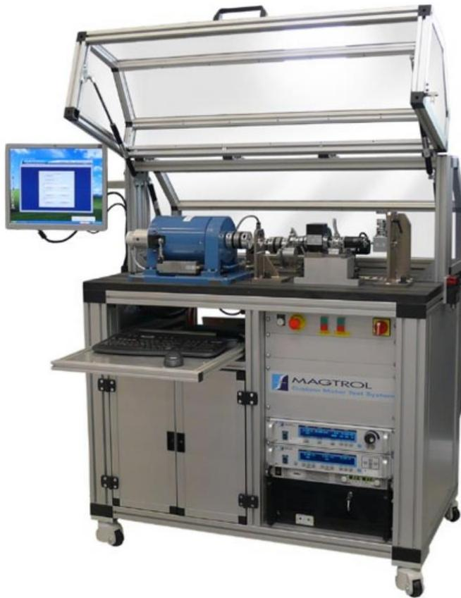
Figura 44 Banco de pruebas para servomotores
