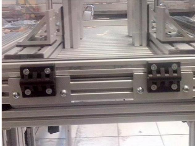
Figura 86 Bisagras montada sobre el banco de pruebas
