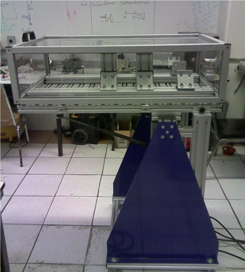
Figura 89 Banco de pruebas para motores eléctricos
