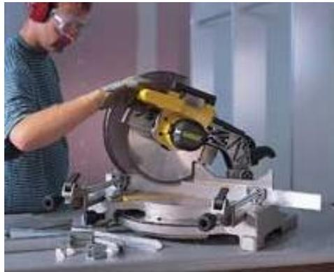
Figura 73 Cortadora de perfil de aluminio
