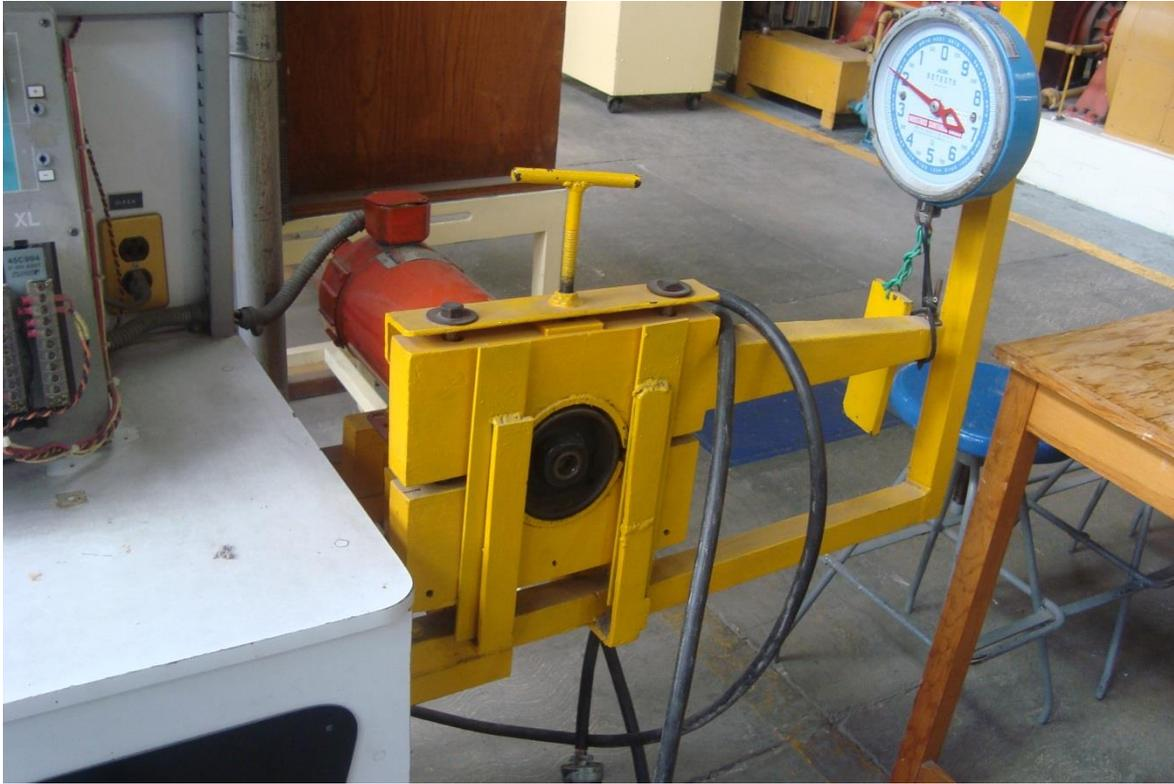
Figura 14 Freno de Prony Laboratorio de máquinas eléctricas
