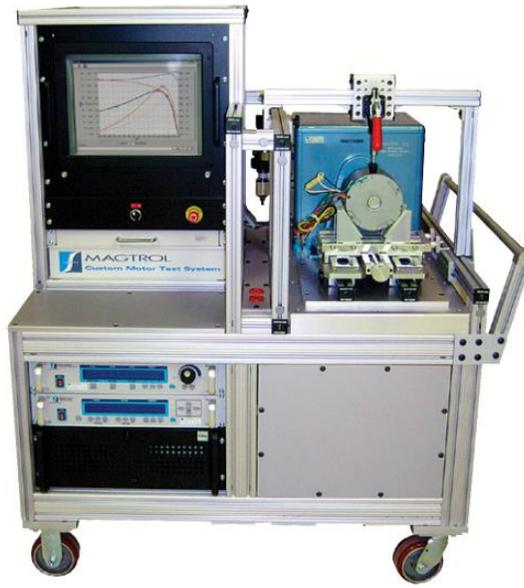
Figura 39 Banco de pruebas para motores Ac y bombas
