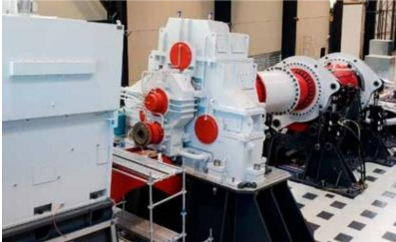
Figura 26 Banco de pruebas para aerogeneradores
