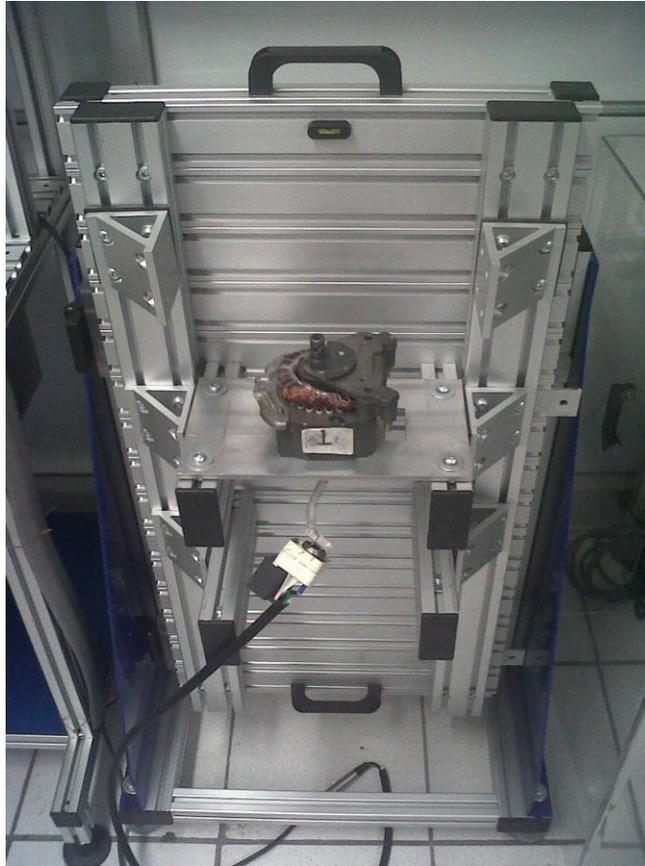
Figura 83 Banco de pruebas: ajuste de elementos mecánicos y motor eléctrico.
