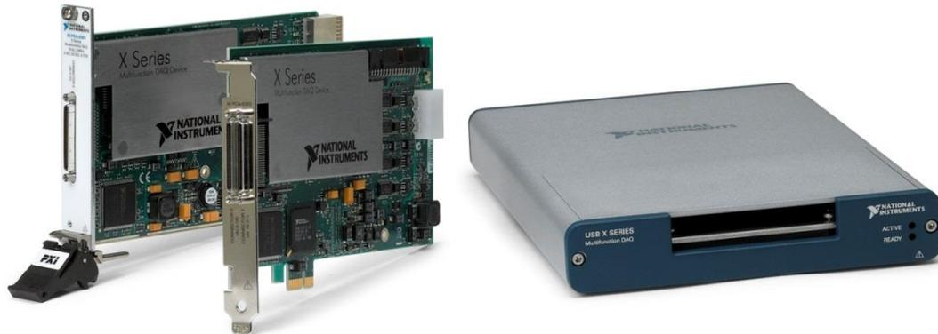
Figura 5 Sistemas de adquisición National Instruments® pci express
