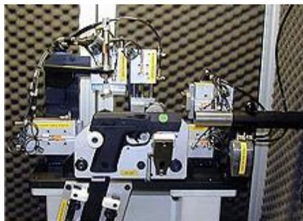
Figura 25 Máquina para pruebas de pistolas de CO2
