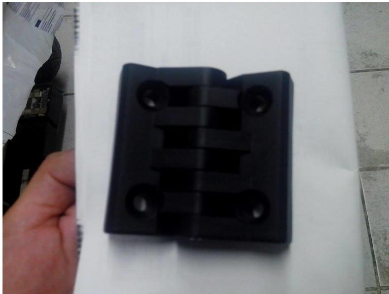
Figura 85 Bisagra para cubierta de protección
