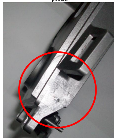
Figura.4.32.- Manchas mate en el punto de inyección
