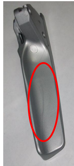
Figura.4.36.- Línea de unión o soldadura
