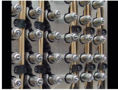
Figura 3.2.- Arreglo de puntos de inyección en un molde de colada caliente [10].
