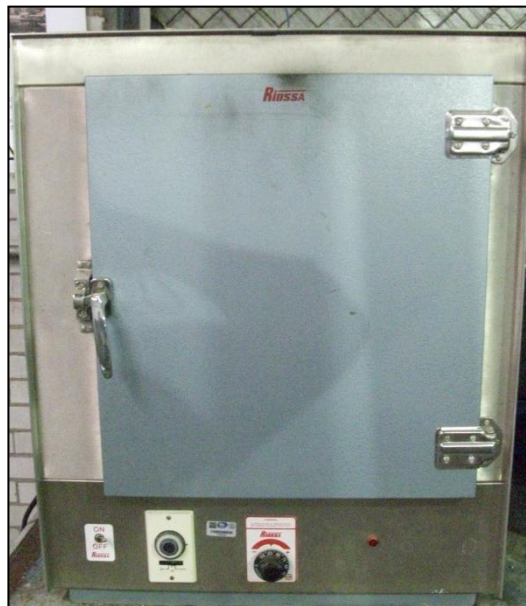
Figura 4.24.- Horno tipo mufla marca RIOS.ROCHA S.A. modelo EC-51 para secar el material.
