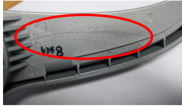
Figura. 4.34.- Línea de unión o soldadura con manchas mate.
