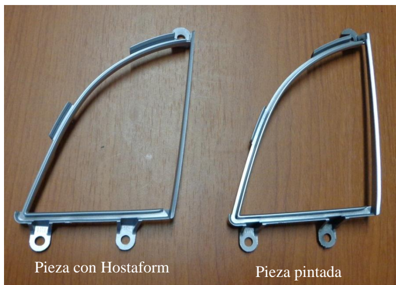
Figura 2.3.- Comparación de pieza de plástico pintada vs. Pieza de plástico con apariencia metálica.
