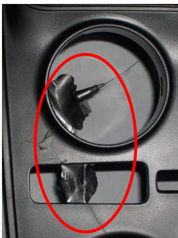
Figura.4.31.- Rebabas en el área de punto de inyección
