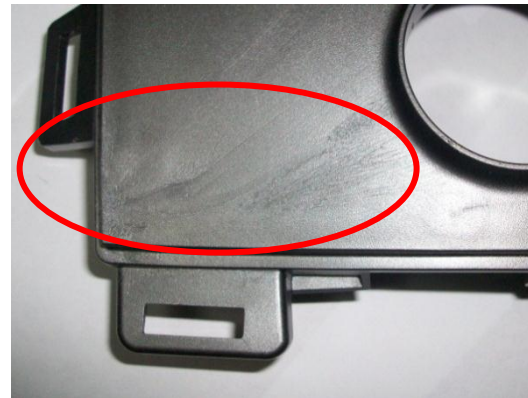
Figura.4.30.-Manchas mate en la parte superior de una pieza
