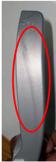
Figura.4.35.- Mancha mate en la parte visual de la pieza
