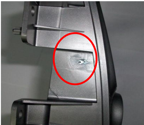
Figura 4.29.- Manchas mate en el punto de inyección
