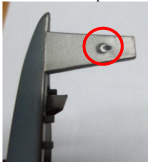
Figura.4.37.- Mancha mate en el punto de inyección
