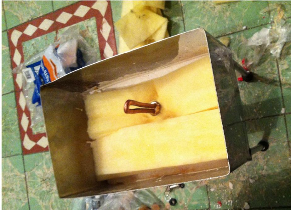
*Figura 4.78 Colocación de 7 capas de aislante térmico de fibra vidrio y plástico para tuberías*
