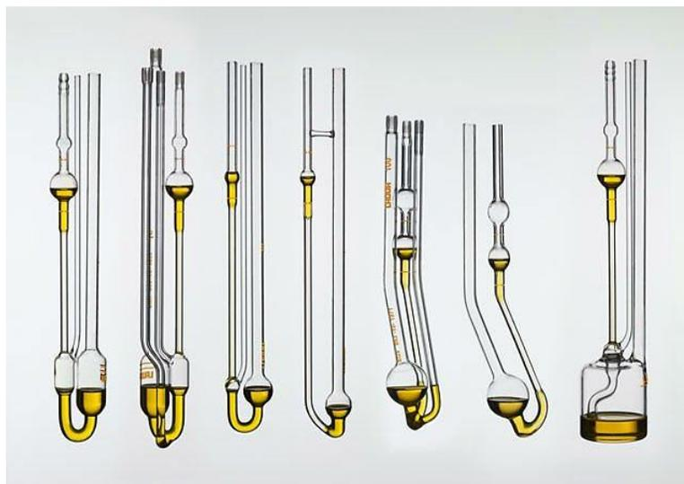
*Figura 1.10. Viscosímetros estándar calibrados capilares de vidrio. [Fuente de la fotografía: LAUDA DR. R. WOBSE GMBH & CO. KG. Alemania].*
