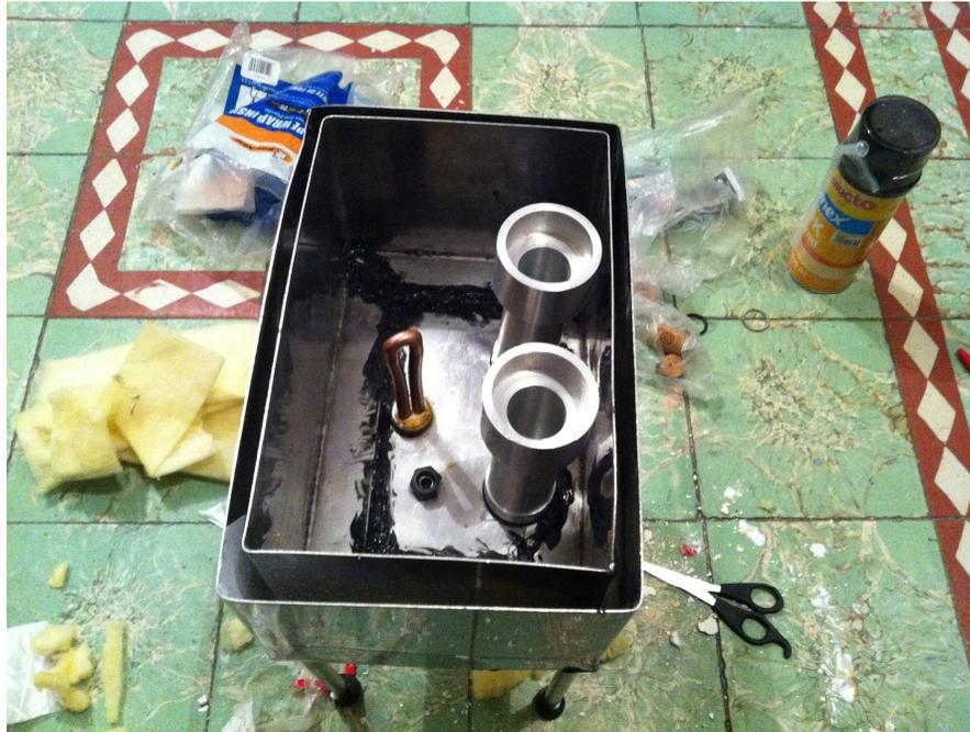
*Figura 4.80 Montaje del Viscosímetro Universal, Furol y la base para el termopar tipo J, cada uno de estos con su respectivo empaque.*
