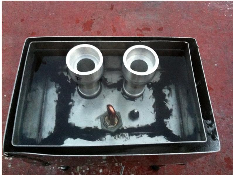
*Figura 4.83 Revisión de que el equipo no presente fugas.*
