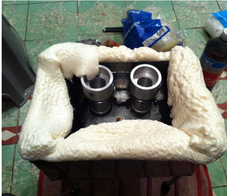
*Figura 4.84 Aplicación de espuma de poliuretano en todos los costados como material aislante.*
