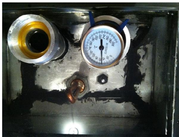
*Figura 5.10 Elevación de la temperatura del aceite a 50 °C.*
