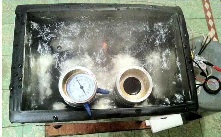
*Figura 5.13 Pruebas con el aceite multigrado SAE 15W-40 a una temperatura de 90 °C.*
