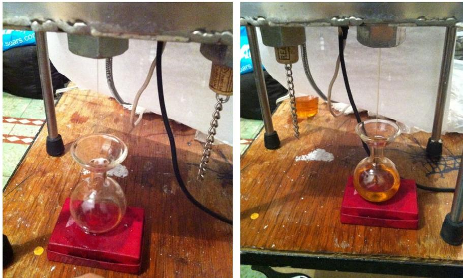
*Figura 5.17 A 40 °C se realizó la prueba en ambos Viscosímetro.*
