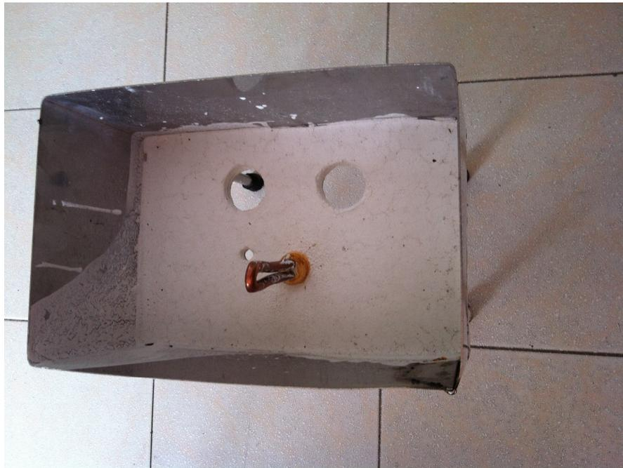
*Figura 4.77 Montaje de la resistencia.*
