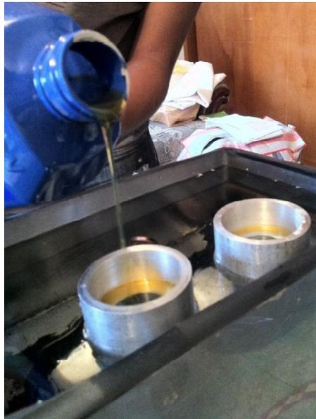
*Figura 5.1 Llenado de aceite SAE 40 de los recipientes utilizados para realizar la prueba.*
