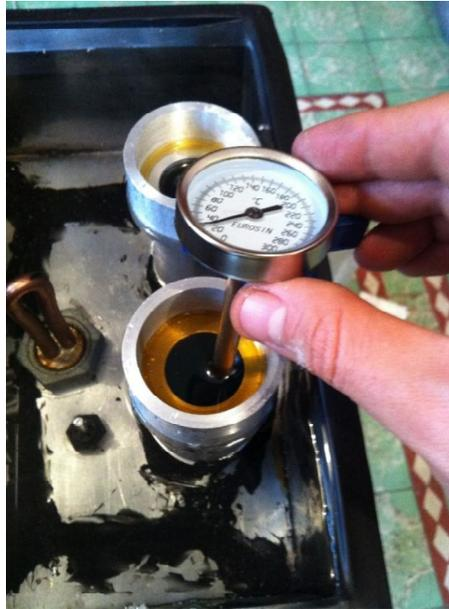
*Figura 5.2 Sumergido del termómetro bimetálico en el aceite.*
