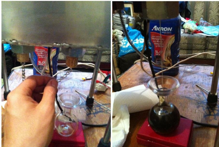
*Figura 5.9 Realización de la misma operación en el Viscosímetro tipo Furol.*
