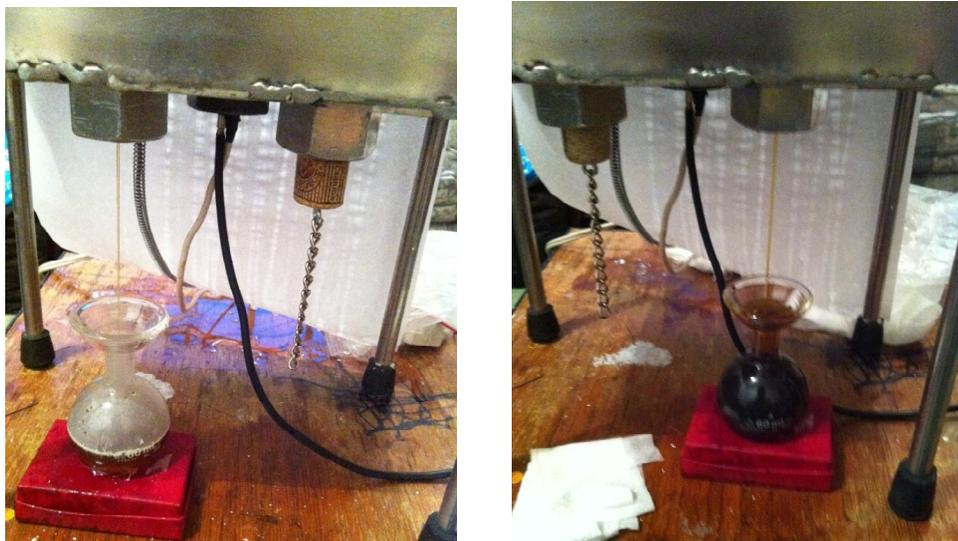
*Figura 5.12 A  $90^{\circ}\text{C}$ , el aceite empaña el matraz y la velocidad con la que fluye aumenta.*
