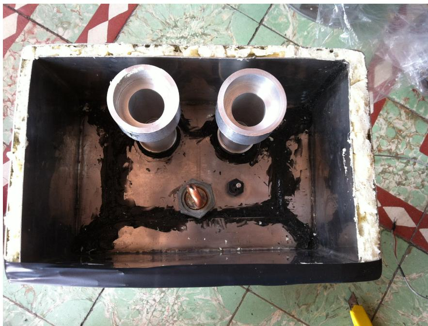
*Figura 4.85 Cortado, lijado y tapado de la espuma de poliuretano.*
