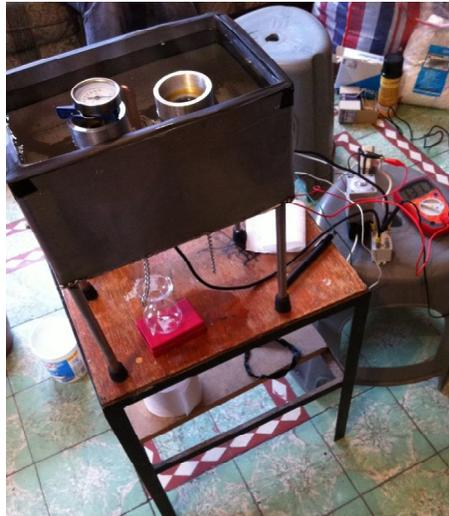
*Figura 5.4 Aceite monogrado SAE 40 a una temperatura de 40 °C en el viscosímetro*
