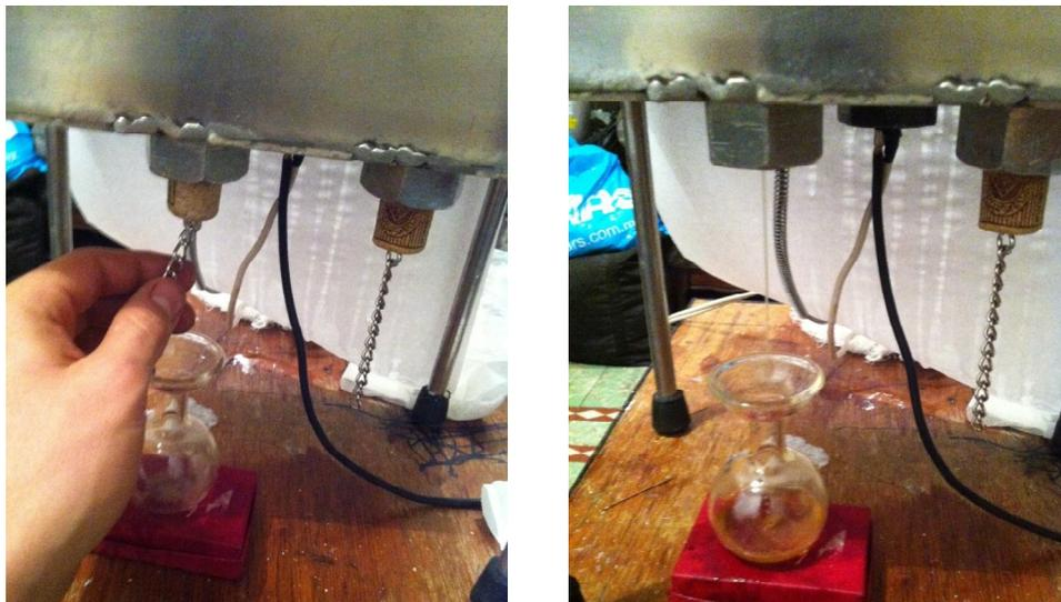
*Figura 5.14 Realización de la operación con el Viscosímetro tipo universal.*
