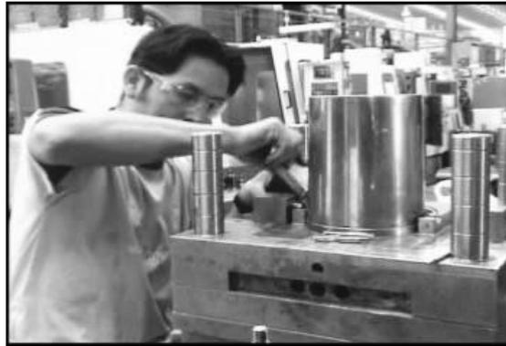
El trabajo primordial del molde de inyección es recibir y distribuir el material plástico fundido para ser formado, enfriado y posteriormente expulsar la parte moldeada.
