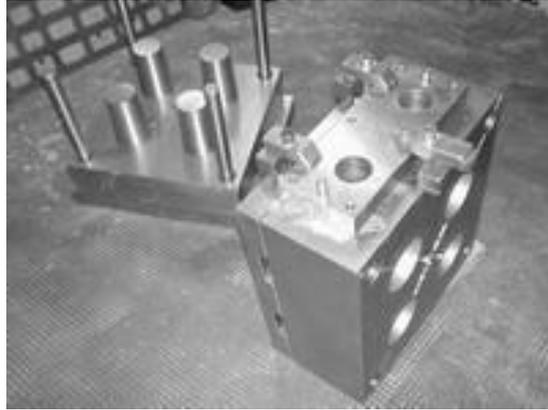
En la construcción de moldes para inyección de plásticos es necesario utilizar aceros especiales por las condiciones de trabajo, debido a las cargas severas a que son sometidos y porque se requiere alta precisión en los acabados. A esto hay que añadir que las tolerancias manejadas son muy finas.
