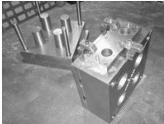
Se monta el molde en la máquina de inyección se revisa la velocidad, presión, posición de cierre y apertura, inyección, sostenimiento, carga y descompresión, expulsor, temperatura.
