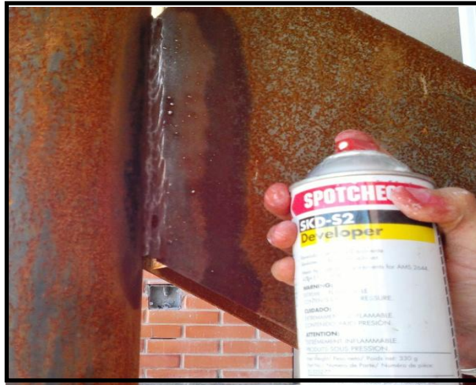
Foto 6.13.- Zona lista para la aplicación del revelador (tercer paso del procedimiento).
