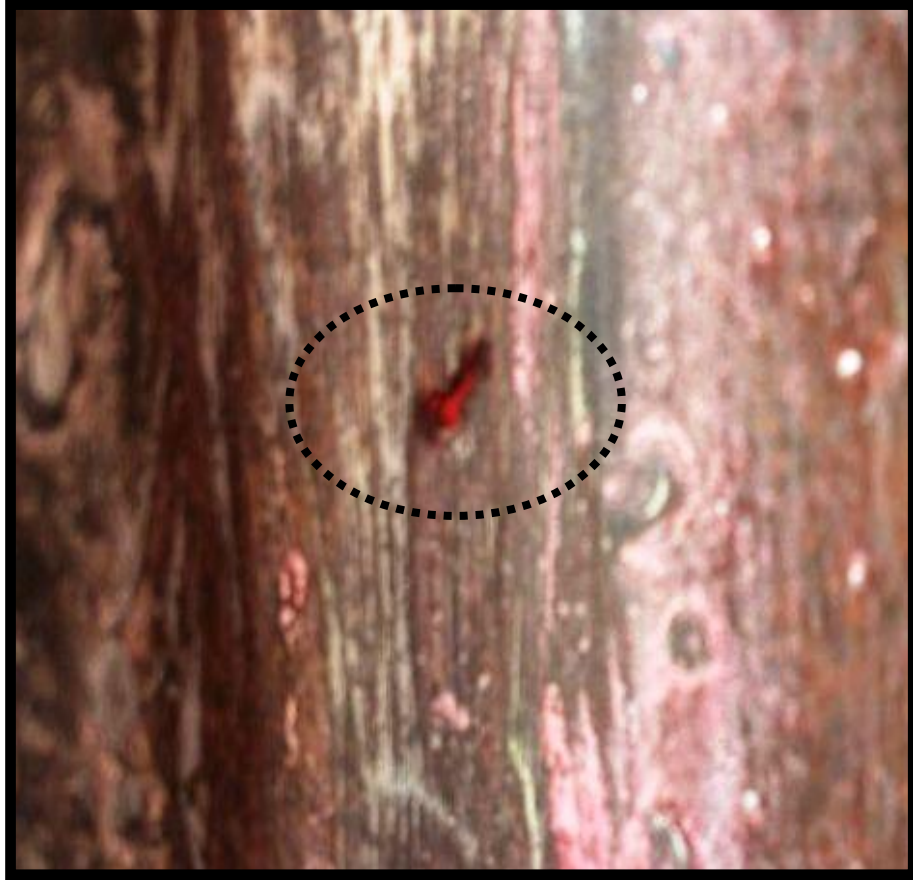
Foto 6.15.- Discontinuidad superficial que se encuentra dentro de los parámetros de tolerancia.
