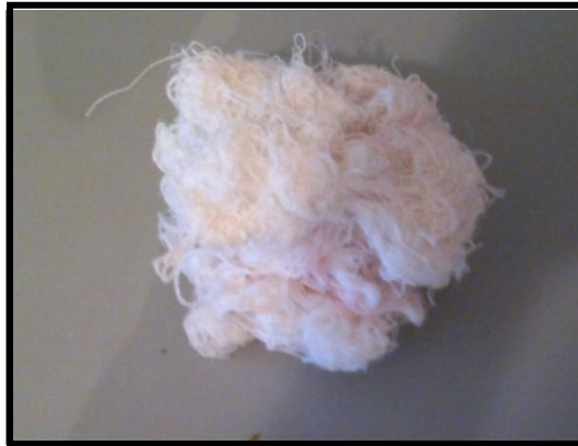
Foto 6.4.- Estopa con la que podría realizarse la limpieza de la superficie.
