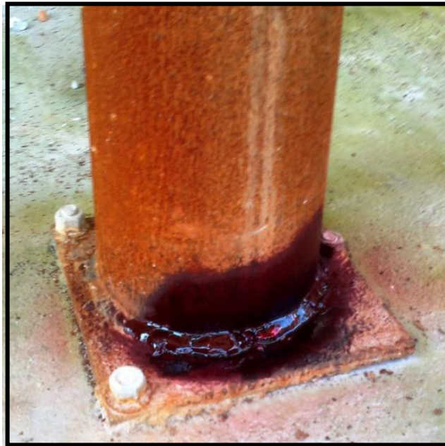
Foto 6.9.- Líquido Penetrante aplicado.
