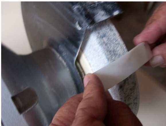
Foto 118. Adelgazamiento de una placa utilizando un esmeril para lograr el espesor deseado
