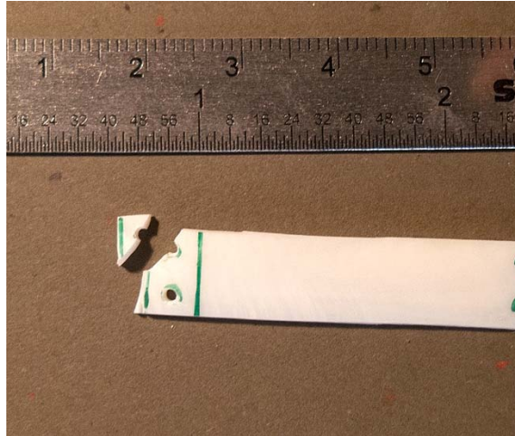
Foto 121. Ruptura de un pendiente durante la manufactura, en una zona cercana a las perforaciones. Es posible que esto hay ocurrido también en la confección de las piezas originales, aunque como se dijo, se ha considerado que las prendas solo se usaron piezas completas
