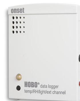
Ilustración 33. Registrador de datos independiente, HOBO data logger U12-012. http://www.onsetcomp.com
