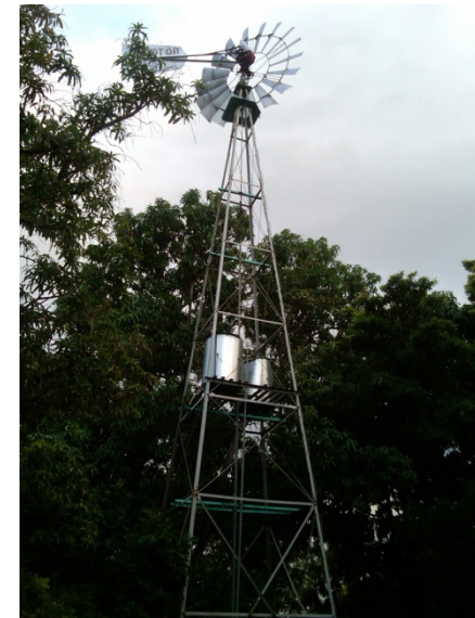
Ilustración 21. Veleta utilizada para la extracción de agua introducida en México desde Estados Unidos en la época del “oro verde” en Yucatán. Foto: Iliana Tarango, septiembre 2011.
