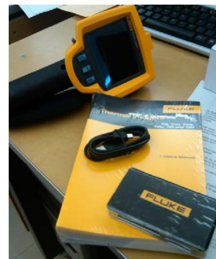
Ilustración 32. Cámara termográfica, marca Fluke. Iliana Tarango, agosto 2011.
